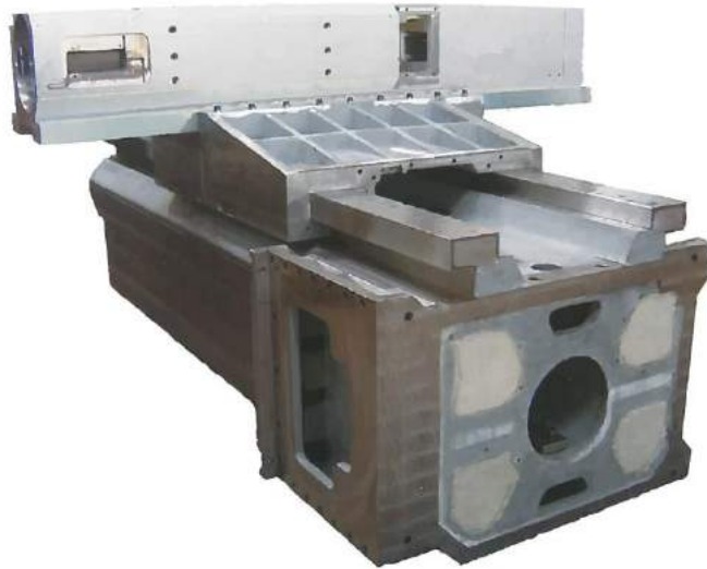
Obr. 44) Litinové lože vylité betonovou směsí [40]
