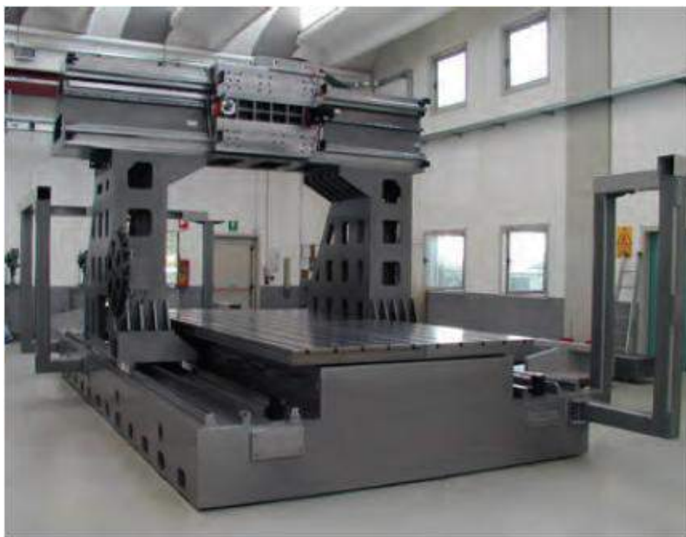
Obr. 27) Svařovaný portál stroje společnosti Benazzato S.r.l. [20]
