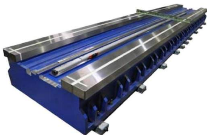
Obr. 28) Lože stroje WFT 13 CNC společnosti Fermat [6]
