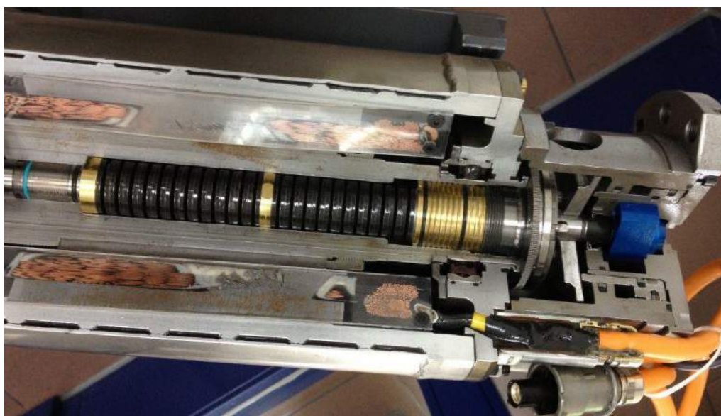
Obr. 32) Vřeteník z vláknového kompozitu od společnosti Compotech [24]
