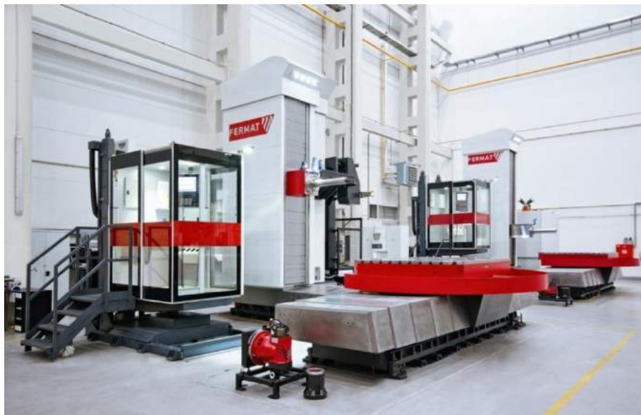
Obr. 6) Horizontální vyvrtávací centrum modulární koncepce[8]
