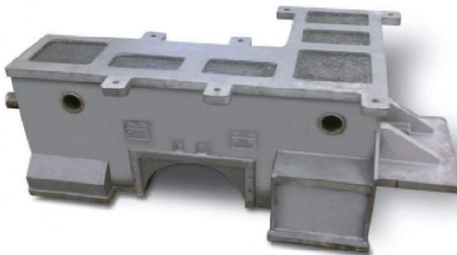
Obr. 47) Základ stroje vyplněný materiálem Zanite Plus [43]
