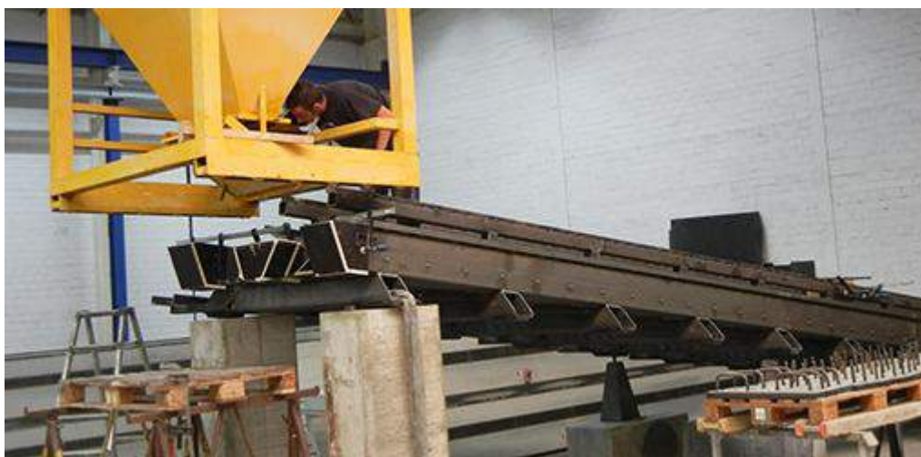
Obr. 46) Lože stroje AT-500 SBZ ve fázi před vylitím [42]
