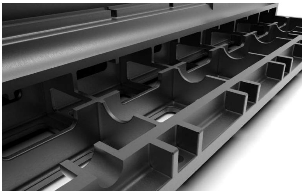
Obr. 60) Pohled na vnitřní žebrování příčného lože stroje WFT 13 CNC
