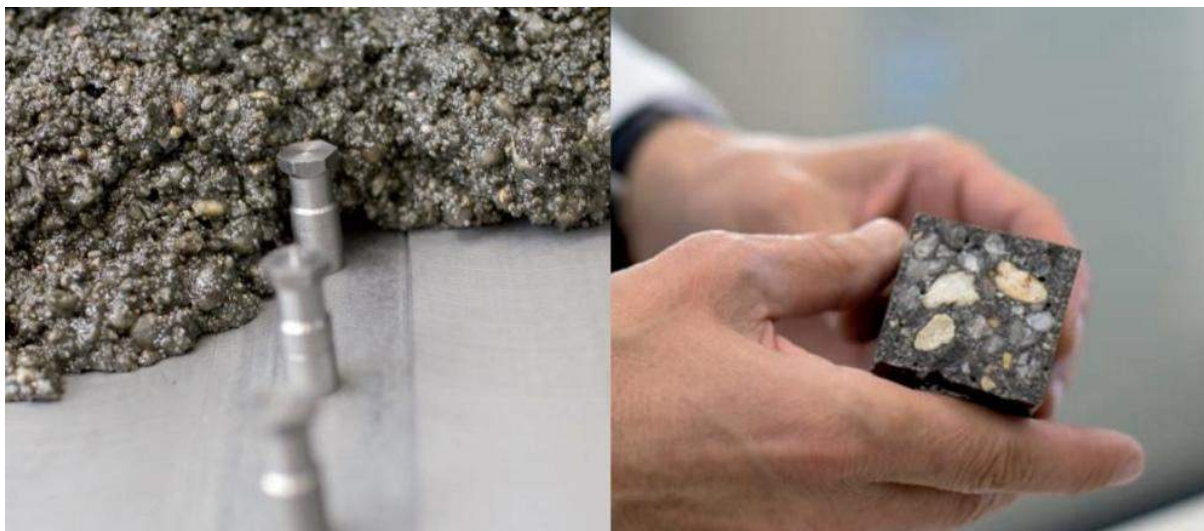
Obr. 37) Polymerbeton EPUMENT – zleva čerstvá a vytvrzená směs [26]
