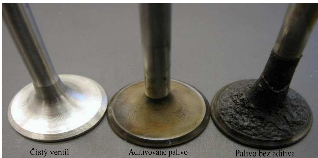
Obr. 3.1 Tvorba úsad na sacích ventilech zážehového motoru [52]
