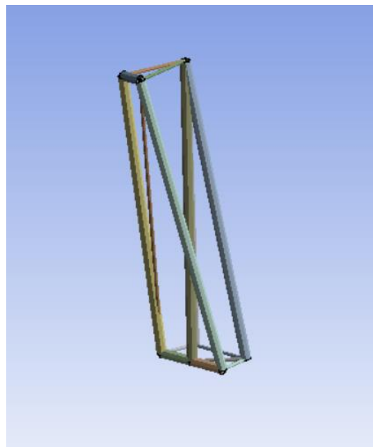
Obrázok 12 - tretie, 4. a 5. poschodie ktoré je staticky určité
