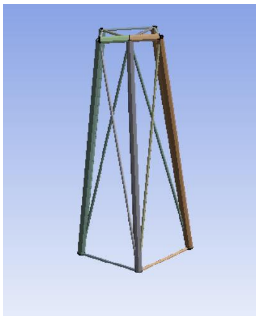
Obrázok 11 - prvé, 2. a 3. poschodie ktoré je staticky určité
