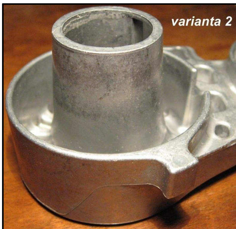
Obr. 64 Odlitek varianta 2 – výskyt vady potlačen
