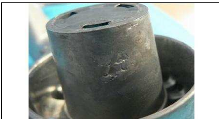
Obr. 28 Zavalenina na vnější stěně difuzoru
