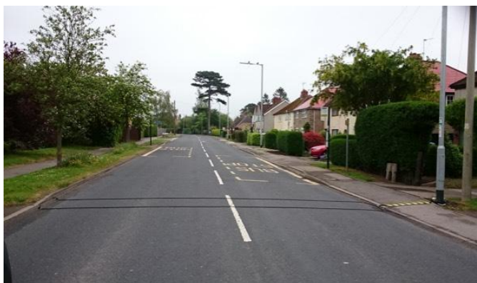
Obr. 14 – Příklad instalace pneumatické hadice [24]
