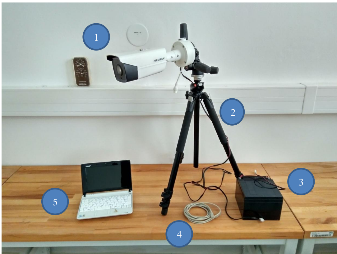
Obr. 26 – Komponenty IP kamery HIKVISION [vlastní]
