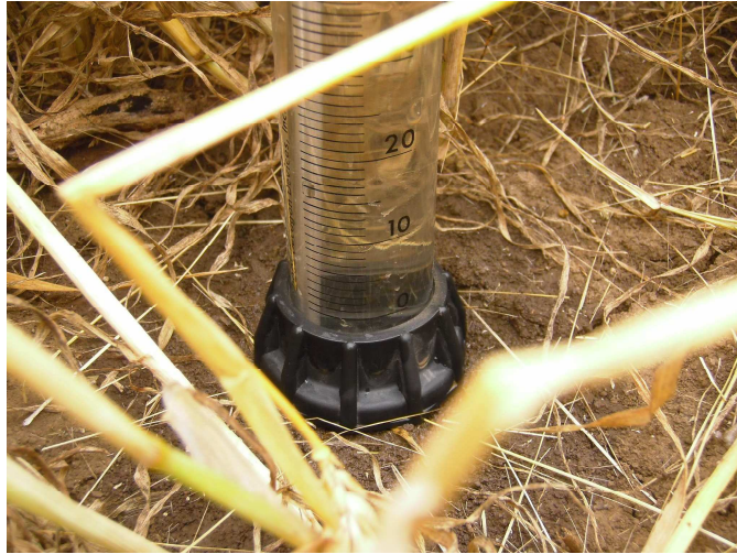
Obr. 4.8. Detail minidiskového infiltrometru (vlastní foto)
