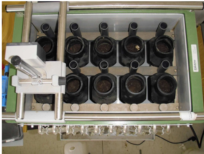
Obr. 4.12 Permeametr se vzorky (vlastní foto)
