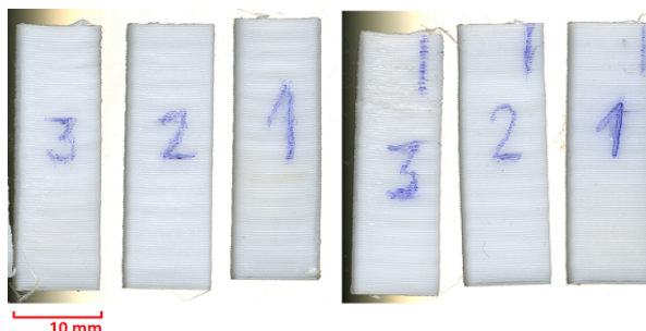
Obrázek 7.18: Porovnání hranatých vzorků o tloušťce 3 mm
