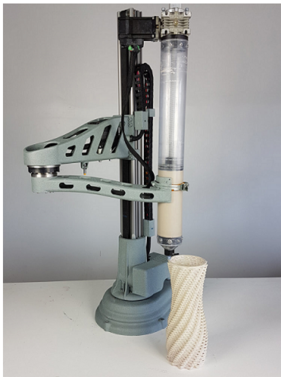
Obrázek 2.9: Schéma SCARA 3D tiskárny [1]
