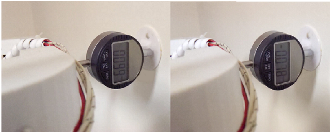
Obrázek 6.6: Maximální a minimální hodnoty odchytky původního rámu v pohybu
