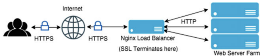
Obrázek 2.2: Nginx vyvažování zátěže a SSL ukončení
