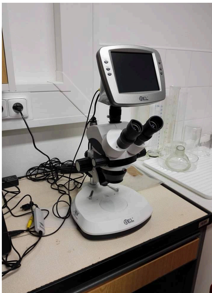
Obr. 30 Makroskop připojený na PC, na kterém byly sledovány a nafoceny netkané textilie s filmem z vodního skla.
