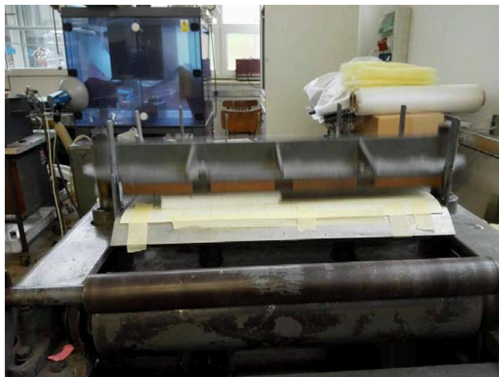
Obr. 29 NT vložená do vpichovacího stroje bez jeh. desky s frekvencí 200 zdvihů za minutu.
