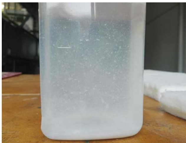
Obr. 19 Koagulace vodního skla po přidání povrchově aktivní látky.
