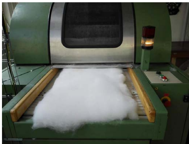
Obr. 22 Druhý cyklus mykání – vkládání vzniklé pavučiny pro optimální promísení vláken.
