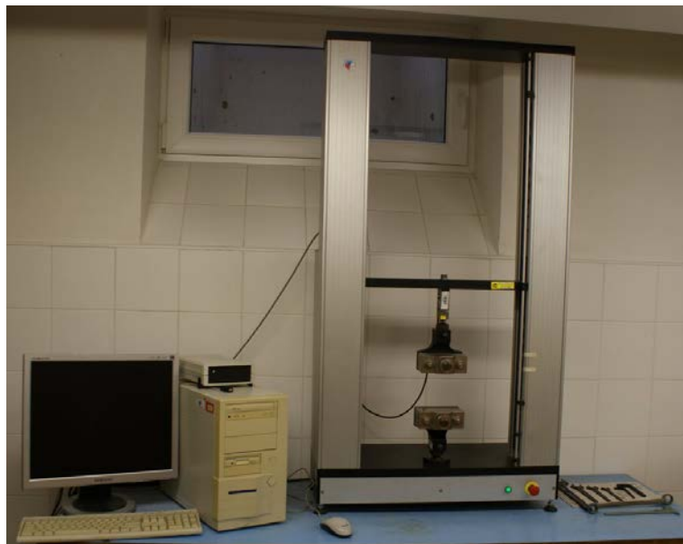
Obr. 15 Univerzální zkušební stroj LaborTech 2.050 pro stlačování netkaných textilií. [26]
