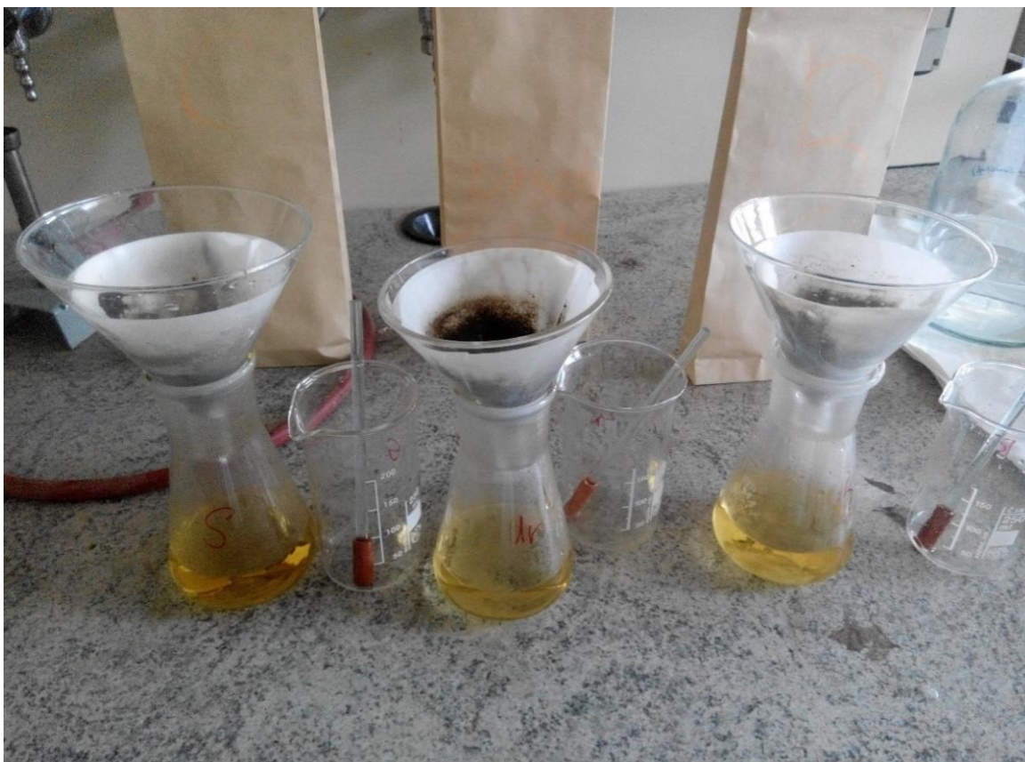
Obrázek č. 23: Vymývání zbytkového \text{Cl}^- z jednotlivých vzorků kompostu
