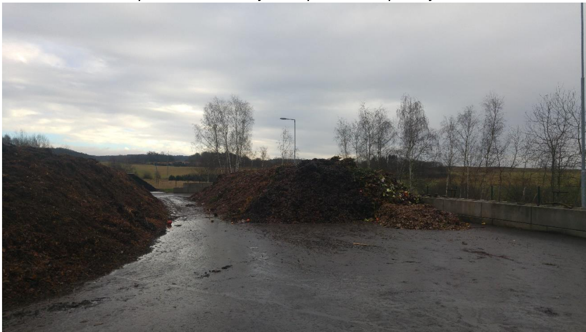
Obrázek č. 12: Kompostovací hromady - kompostování v pásových hromadách
