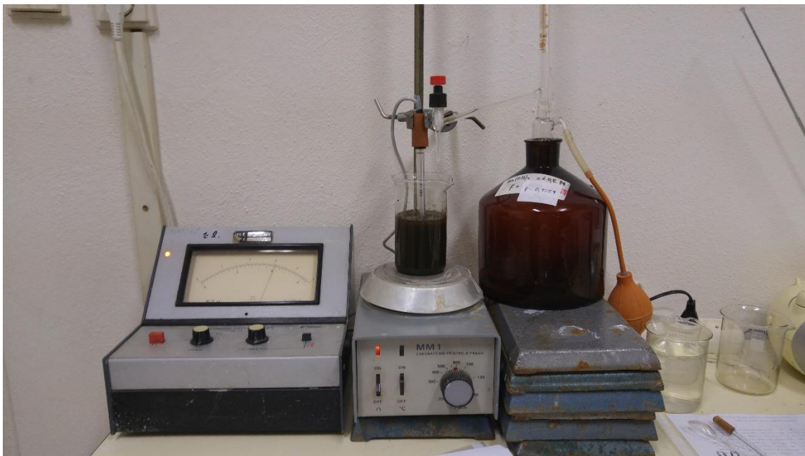
Obrázek č. 22: Titrace roztokem \text{Ba}(\text{OH})_2
