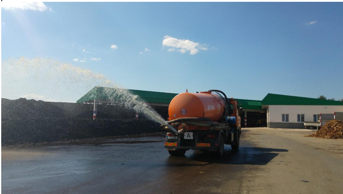
Obrázek č. 11: Zalévání kompostu při kompostování v pásových hromadách na volné ploše
