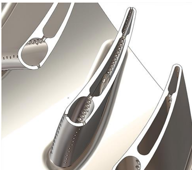
Obrázok 49: Lopatky rotorovej časti motora vyrobených pomocou aditívnych technológií [34]
