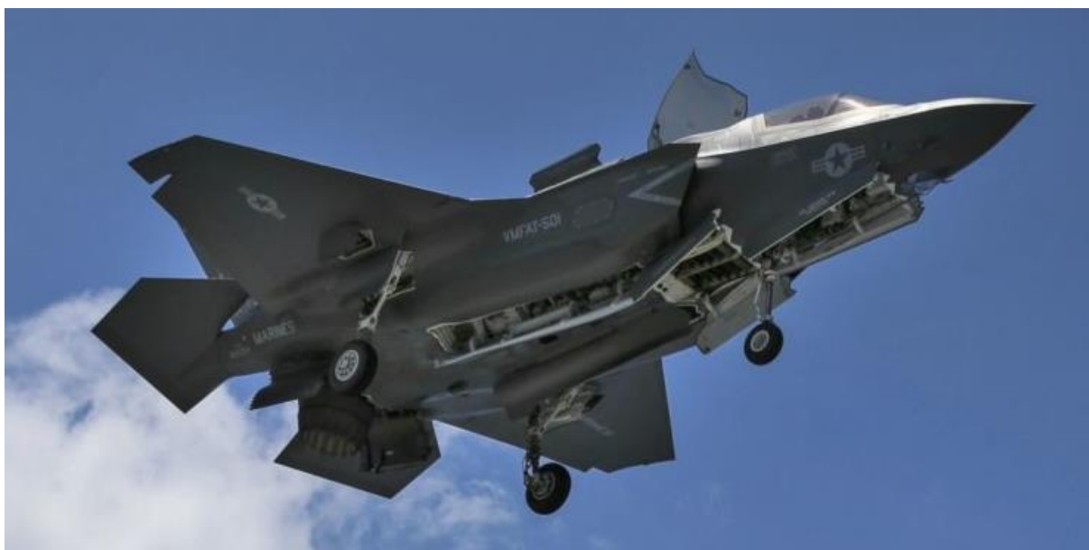
Obrázok 45: Kolmý vzlet lietadla F – 35 pomocou vektorovania ťahu [21]
