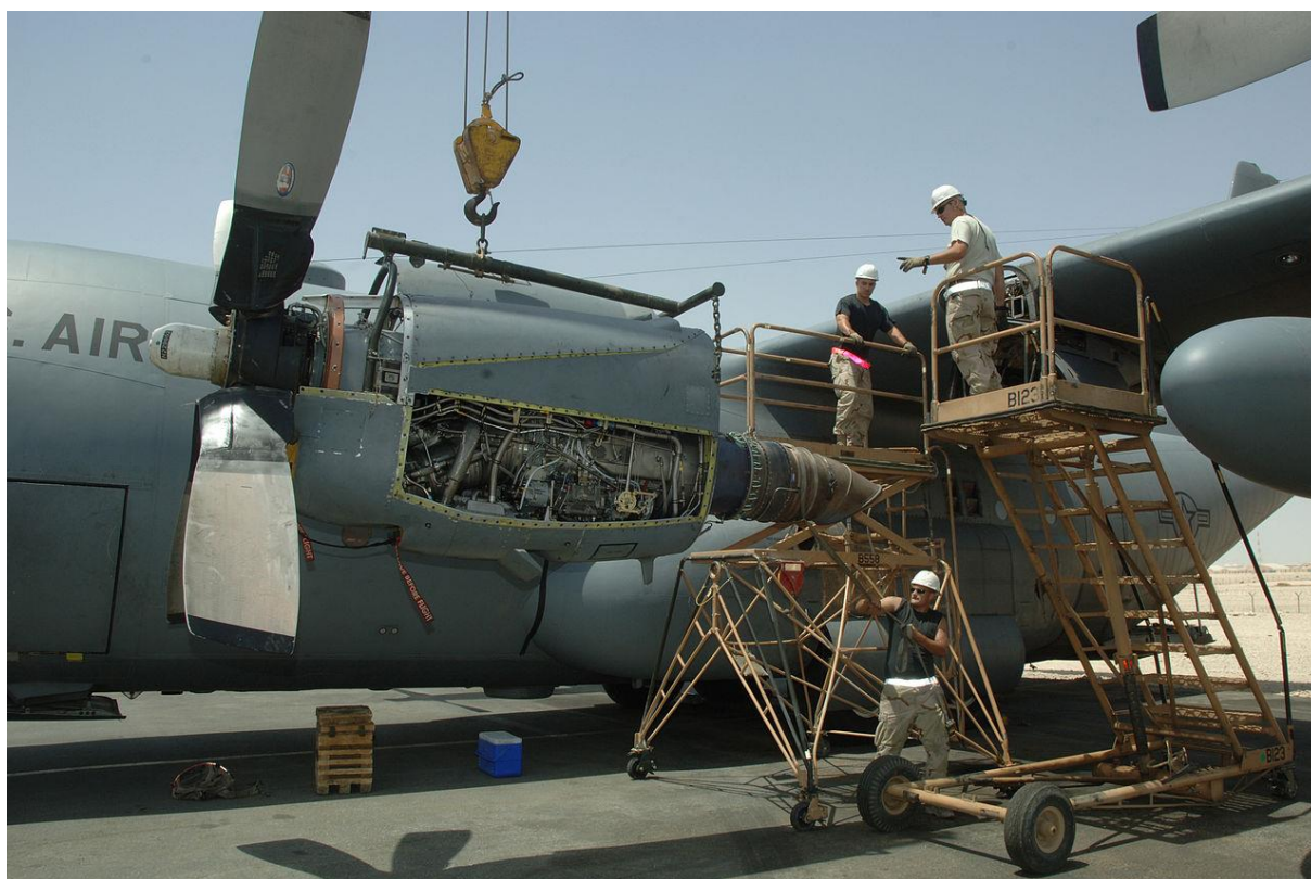
Obrázok 25: demontáž motora General Motors T56 – A – 7 z lietadla KC - 130 Hercules [6]
