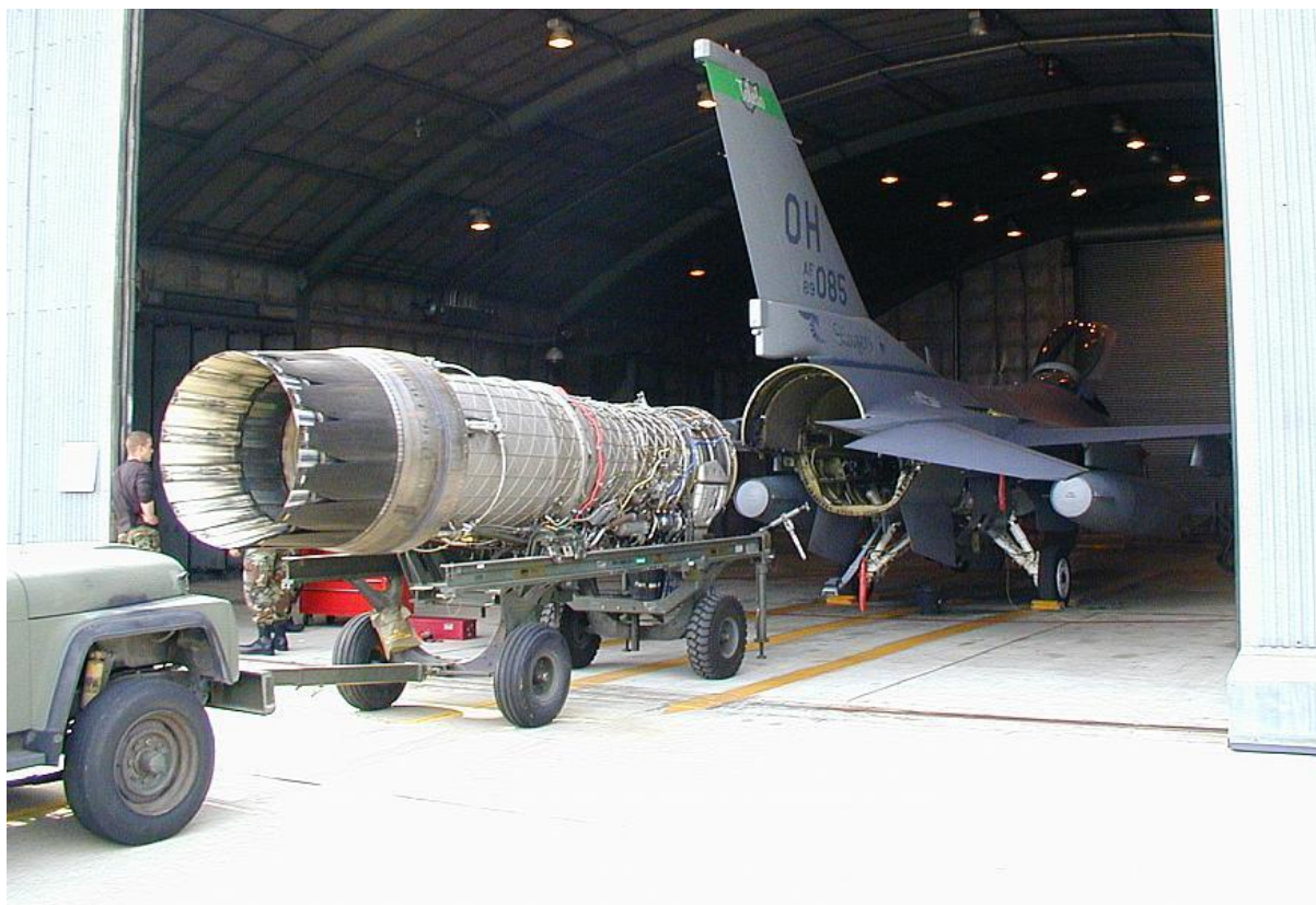
Obrázok 23: Montáž motora Pratt &Whitney F100 – PW – 229 do lietadla F – 16 [17]
