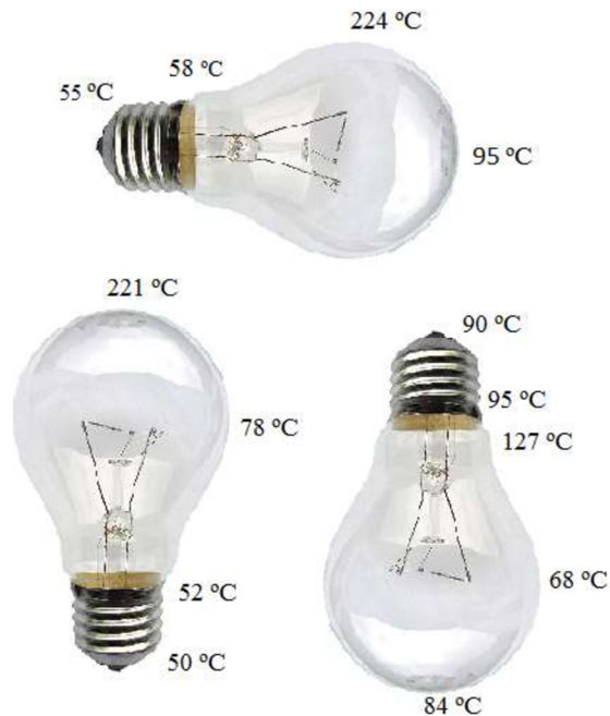
Obr. 4-3 Rozložení teploty na povrchu rozsvícené obyčejné žárovky v závislosti na její poloze [12]
