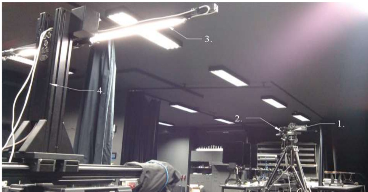
Obr. 5-2 Rozmístění přístrojů pro snímání jasů a změny rozložení teploty lineární zářivky (1.termokamera, 2.fotoaparát Nikon D90, 3. zkoumaný objekt, 4. goniofotometr)
