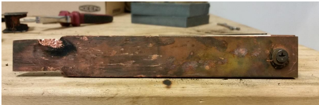
Obr. 4.3-7 Vplyv opaľovania elektródy (katódy) elektrickým oblúkom
