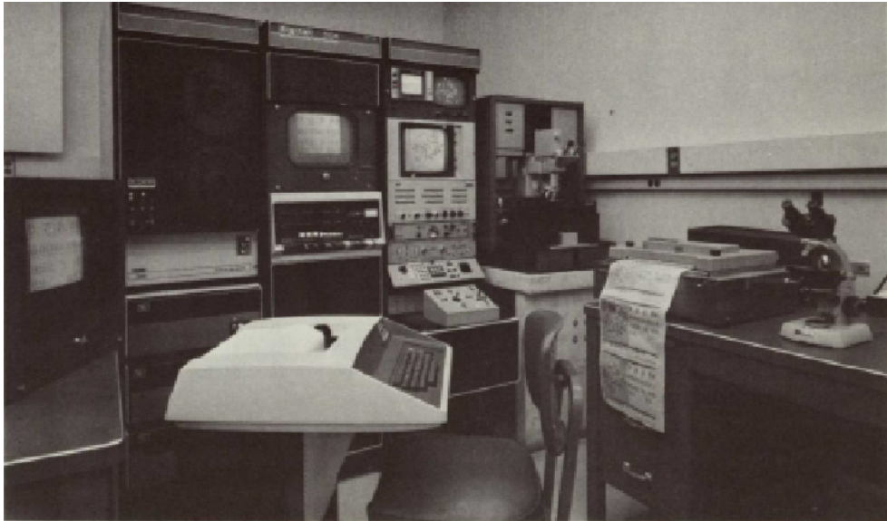
Obr. č.2: Prvý automatizovaný cytogenetický systém (Castleman et al. , 1976).
