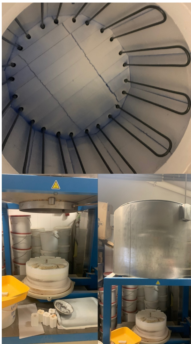
Obrázok č. 15: Pec s riadenou atmosférou CLASIC 501
