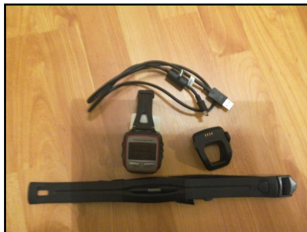
Obrázek 11: Sporttester Garmin Forerunner 305 (1.), hrudní pás – vysílač (2.), USB kolébka (3.), kabel USB pro propojení s PC (4.)
