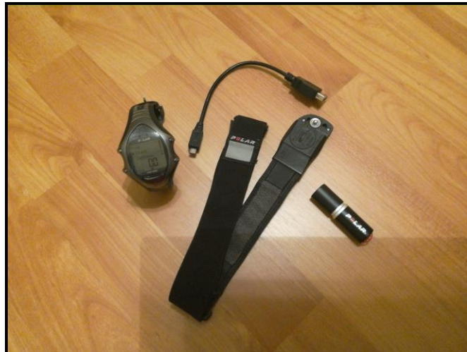
Obrázek 10: Sporttester Polár RS 400 (1.), hrudní pás – vysílač (2.), Polar USB IrDA, interface pro přenos dat (3.), kabel USB pro propojení s PC (4.)
