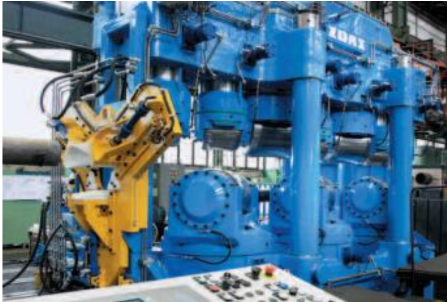
Obrázok 6: Príklad zariadenia valcovní – rovnačka pre rovanie tyčí XRX 15-100 – inovácia 2017 Zdroj: CEFCH CHINA
