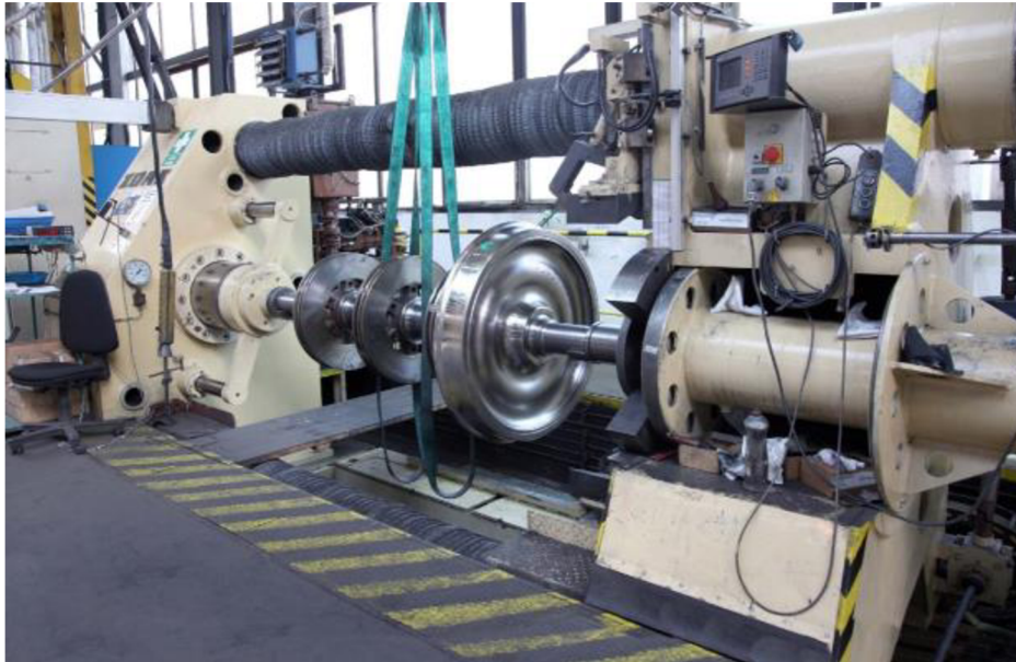
Obrázok 4: Príklad zariadenia tvarovacieho stroja - hydraulický lis CDRA - inovácia 2017
