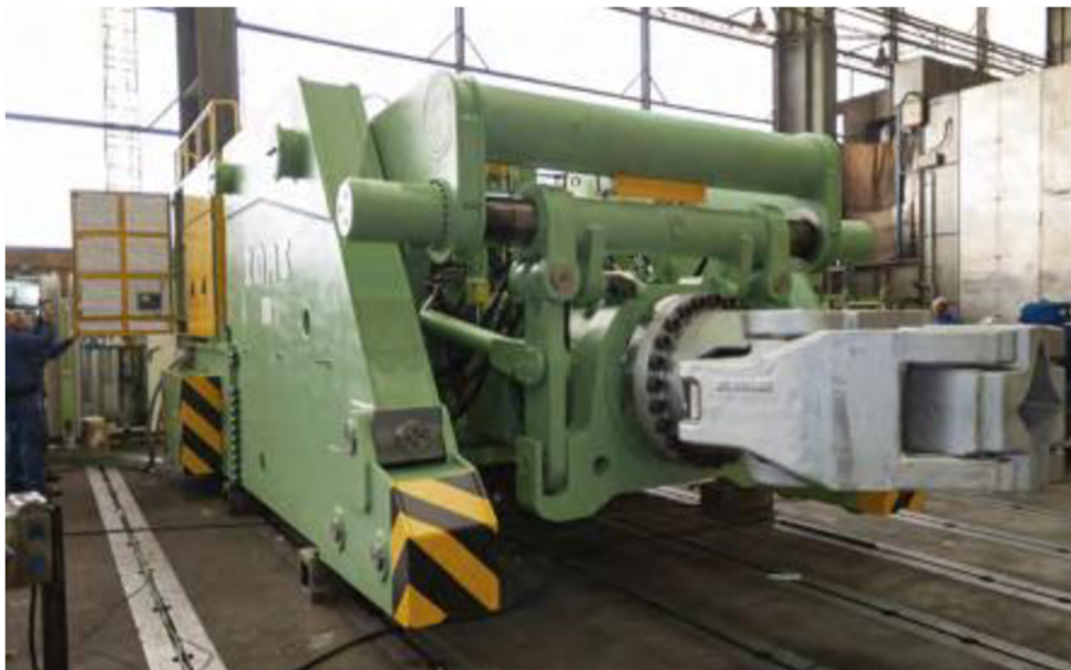
Obrázok 8: Príklad zariadenia pre voľné kovanie – vývoj manipulátoru QKK 20 – inovácia 2017 Zdroj: OPEN-DIE FORGING EQUIPMENT
