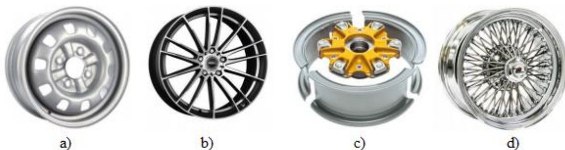
Obrázek 1 - Druhy kol dle konstrukce: a) diskové kolo, b) paprskové kolo, c) hvězdicové kolo, d) drátové kolo [12], [13], [14], [15]
