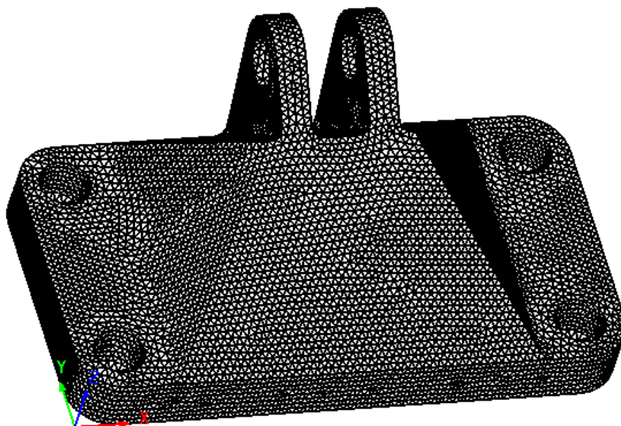
Obr.20 Síť návrhové oblasti pro topologickou optimalizaci konzoly, Z88A
