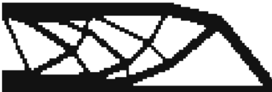
Obr.8 Výsledek optimalizace 2D úlohy použitím BESO. [5]
