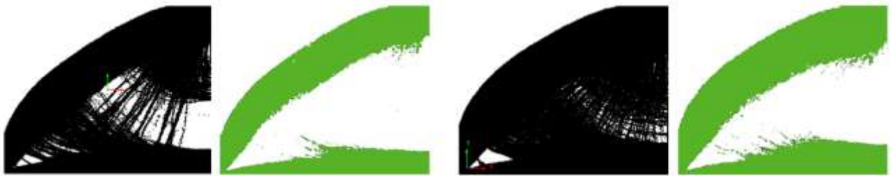
Obr.34 Zanikání jemných struktur 55% a 65% při exportu z Z88A, vlevo vizualizace v postprocesoru, vpravo export
