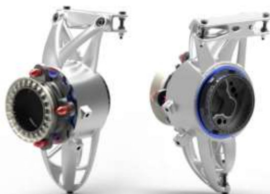
Obr.1 Topologická optimalizace nosiče zadního kola vozu Dragon 8 týmu TU Brno Racing
