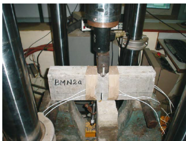
Obr. 1.1: Zkouška trámce velikosti small. Převzato z [9]
