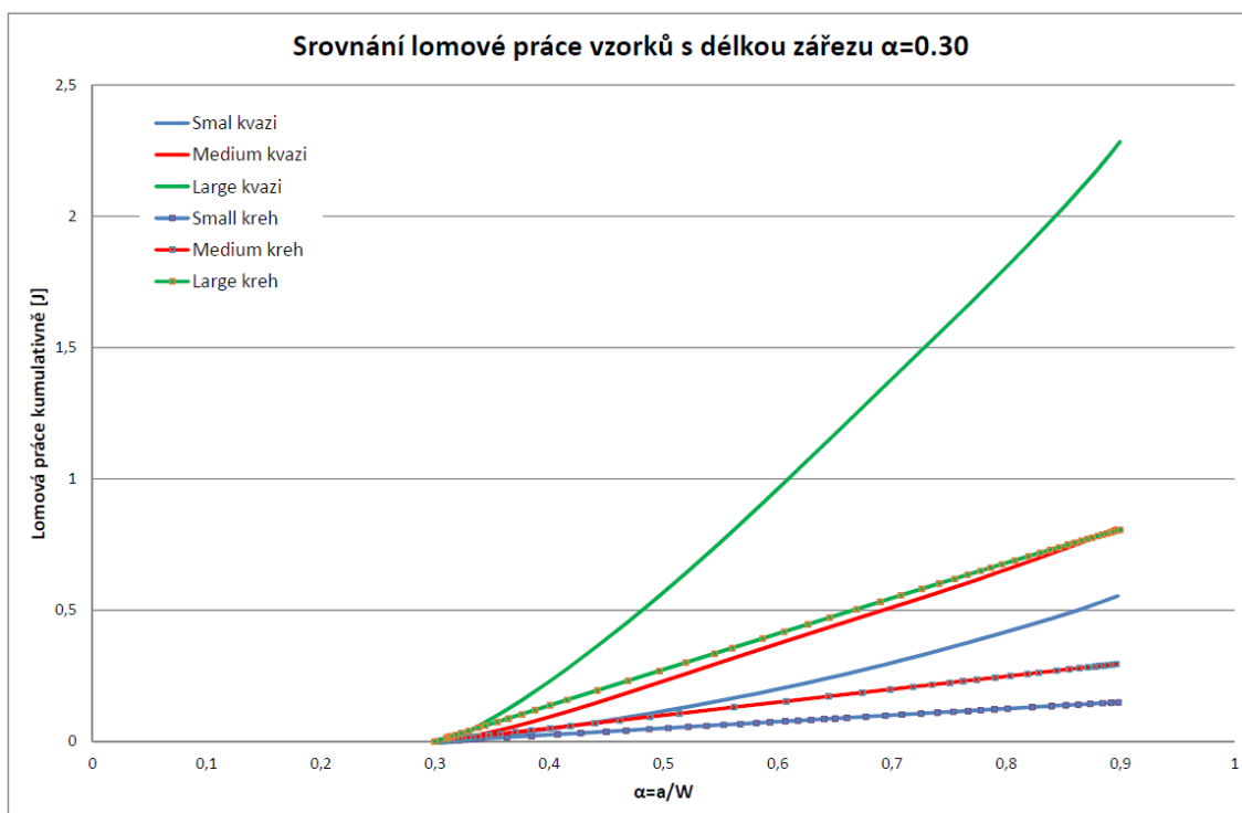
Obr. 3.3: Srovnání lomové práce pro tělesa s relativní délkou zářezu \alpha = 0,30
