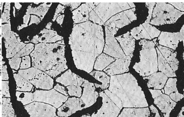
Obr. 5b Feritická struktura u LLG po vyžhání (500x) [6]
