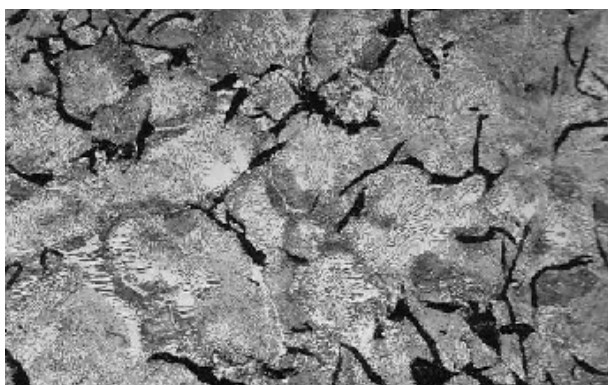
Obr. 6a Perlitická struktura u LLG (200x) [6]
