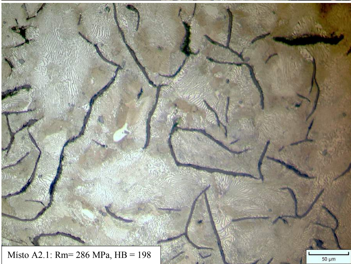
Obr. 44 Struktura vzorků s maximální a minimální tvrdostí z odlitku typu A
