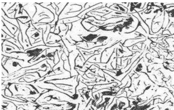
Obr. 5a Feritická struktura LLG (100x) [3]
