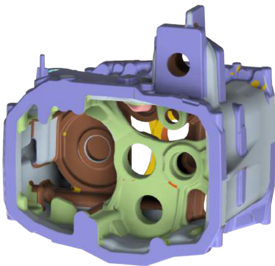
Obr. 33a Odlitek typu A, GJL 300 Cu+Cr, hmotnost 185 kg
