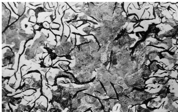
Obr. 8a Feriticko-perlitická struktura u LLG (200x) [6]
