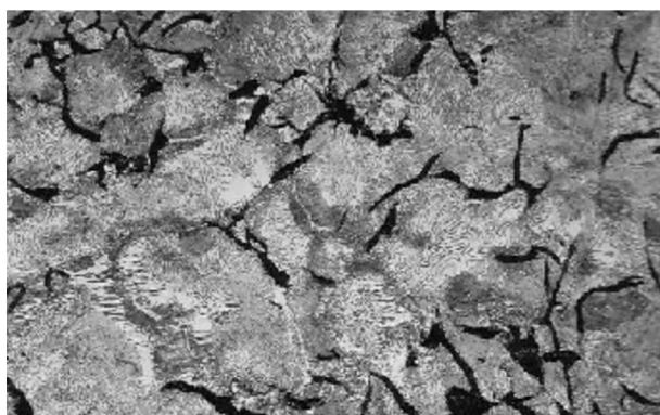
Obr. 6a Perlitická struktura u LLG (200x) [6]
