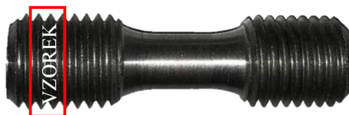
Obr. 42 Místo odběru vzorků ze zkušebních těles pro metalografickou analýzu
