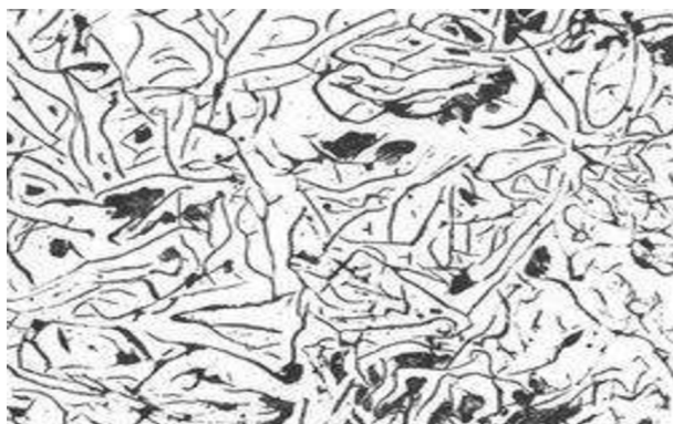
Obr. 5a Feritická struktura LLG (100x) [3]
