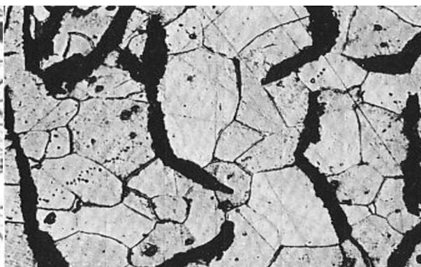
Obr. 5b Feritická struktura u LLG po vyžihání (500x) [6]
