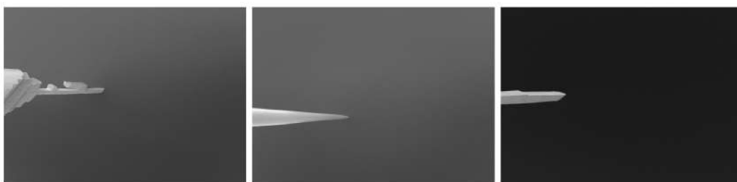
Obrázek 6.5: Příklad obrázků z datasetu Welding Manipulator bez lamely, která pravděpodobně upadla z transportní jehly.
