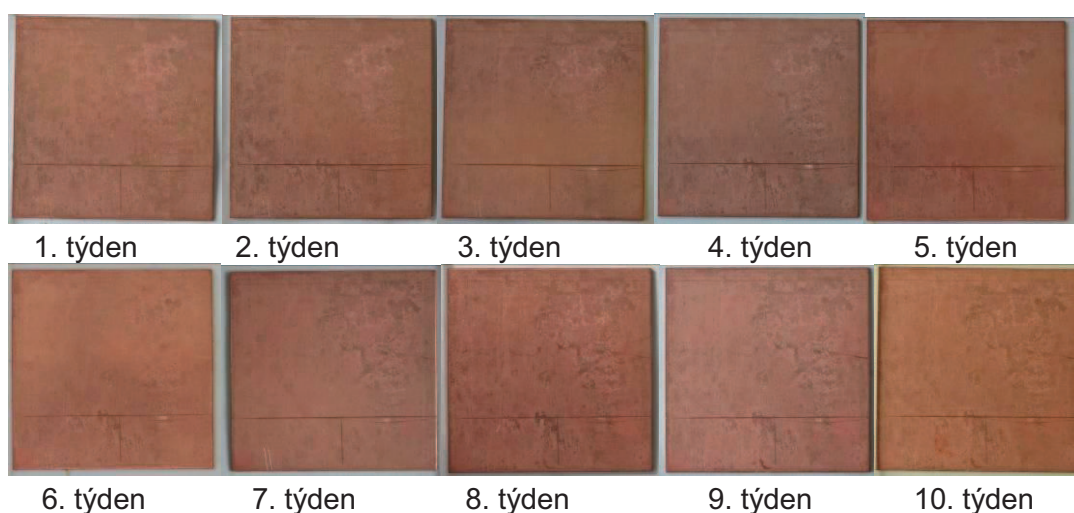
Obr. 27 Vzorek v průběhu korodování
