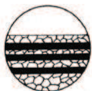
Obr. 10 Koroze po vrstvách [47]
