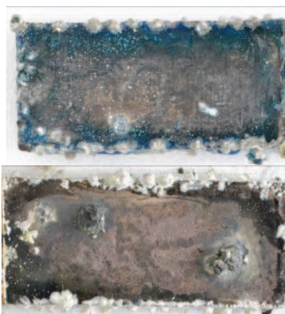
Obr. 40 Ukázka zkorodovaného vzorku (nahore) a vzorku po ošetření (30 sccm vodíku, 20 sccm argonu)
