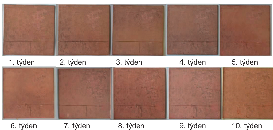
Obr. 27 Vzorek v průběhu korodování
