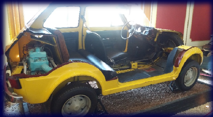
Obr. 25 Řez vozem Fiat 126p „Maluch,,
