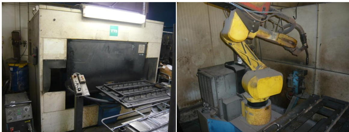
Obr. 9 Svařovací robotická buňka (vlevo) a robotické rameno Kocks typ: BASIC-TT-N-P100E EWM 400-A-EAS (vpravo)
