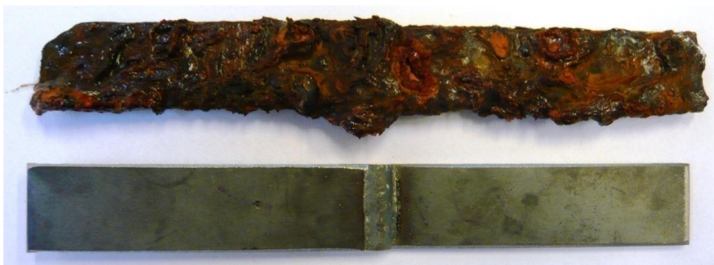
Obr. 27 Srovnání zkušební vzorku před a po 105 dnech v prostředí solné mlhy
