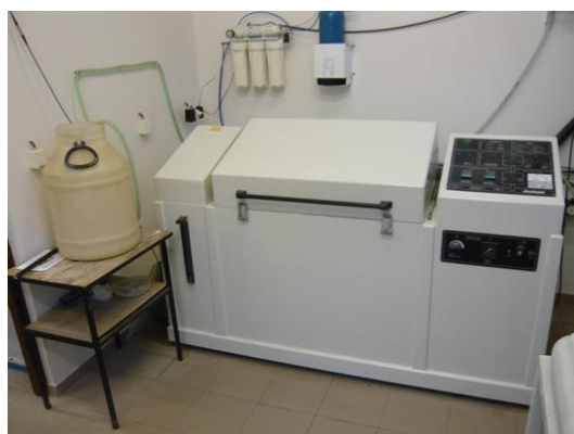
Obr. 26 Řez solnou komorou (vlevo) [11]; Solná komora S400-TR (vpravo)
