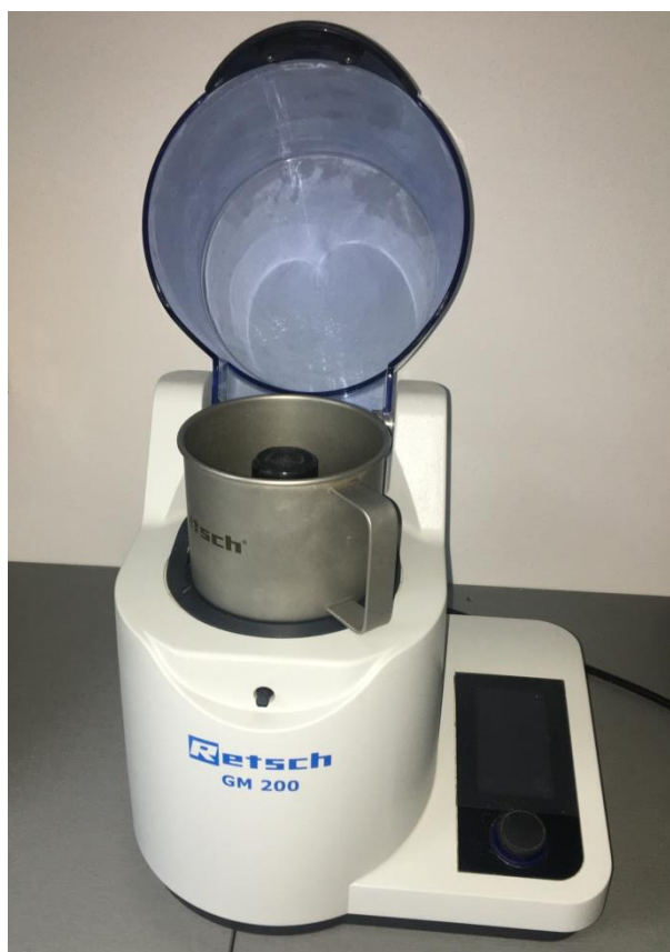
Obrázek 2: Nožový mlýn Gridomix GM200 (Retsch). (Kotašková, 2022)
