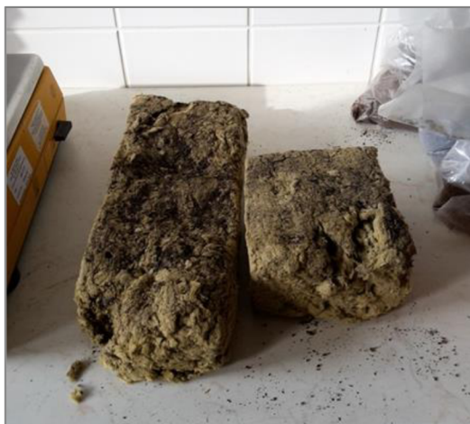
Obr. 7 – Detail vzorku OH76 po 16 měsících, bez vegetace, vysušený
