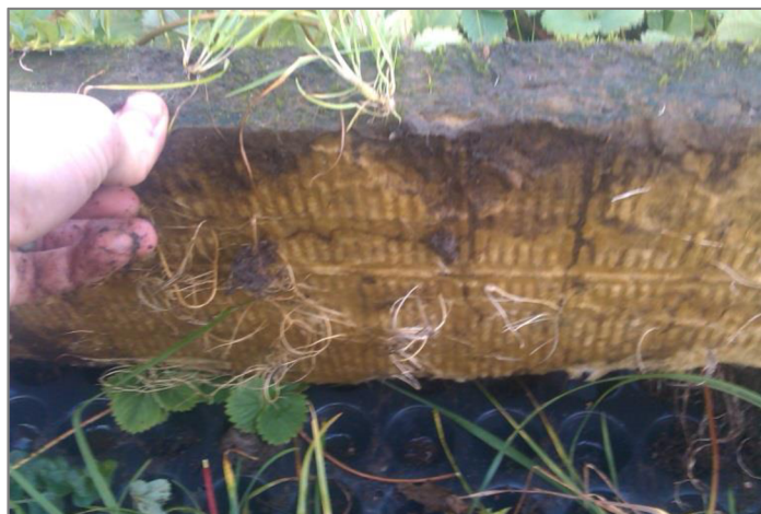
Obr. 8 – Jemné prokořenění trávou desek OH120 při odběru vzorků
