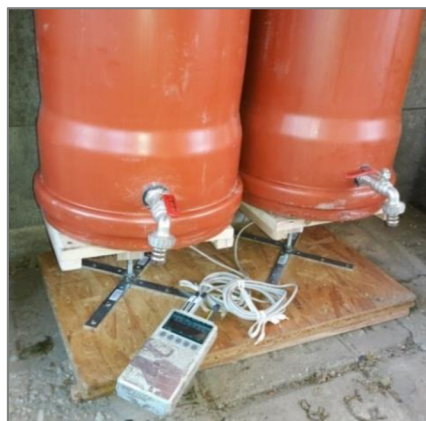
Obr. 3 – Měřicí sestava s datalogerem
