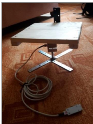
Obr. 2 – Podstavec s hmotnostním čidlem
