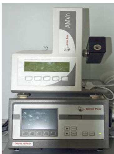
Obr. 21 Automatický Mikro Viskozimetr AMVn kombinovaný s měřičem hustoty DMA 4500
