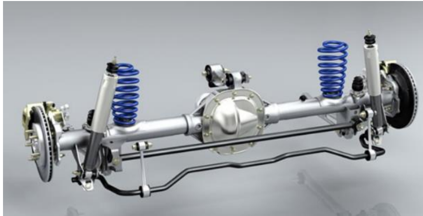
Obr. 16 Poháněná zadní náprava automobilu Ford Mustang [7]
