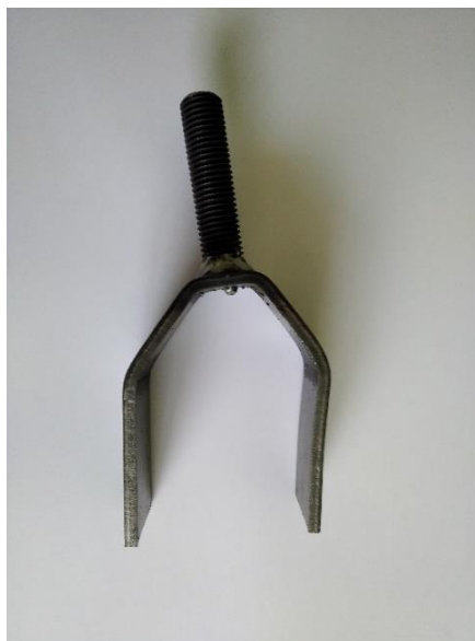
Obr. 46 Deformace zkušebního vzorku na tlak
