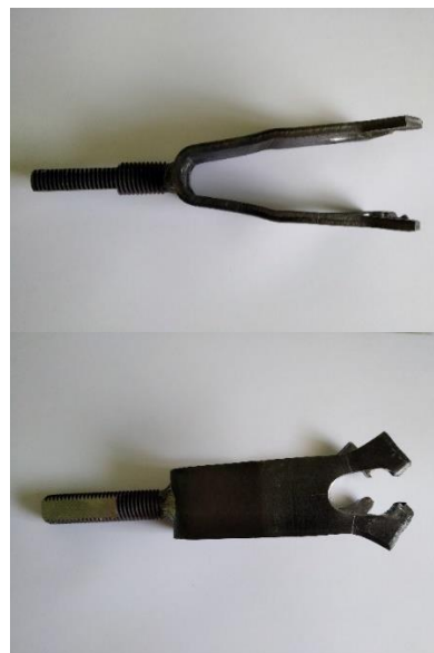
Obr. 47 Deformace vzorku na tah
