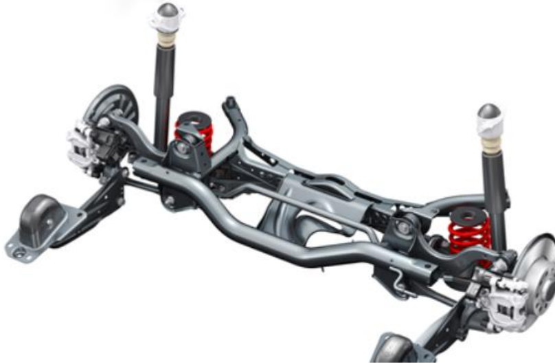
Obr. 27 4-prvkové zavěšení zadní nápravy VWGolf V [13]
