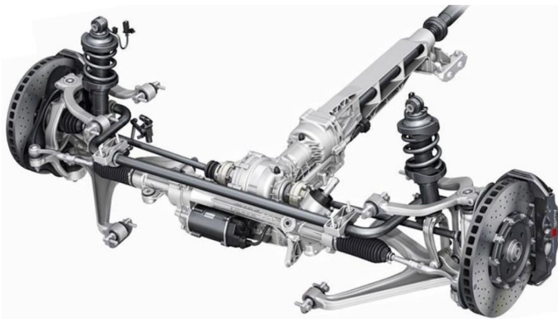
Obr. 20 Přední lichoběžníková hnací náprava AUDI A8 [9]
