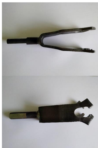
Obr. 47 Deformace vzorku na tah
