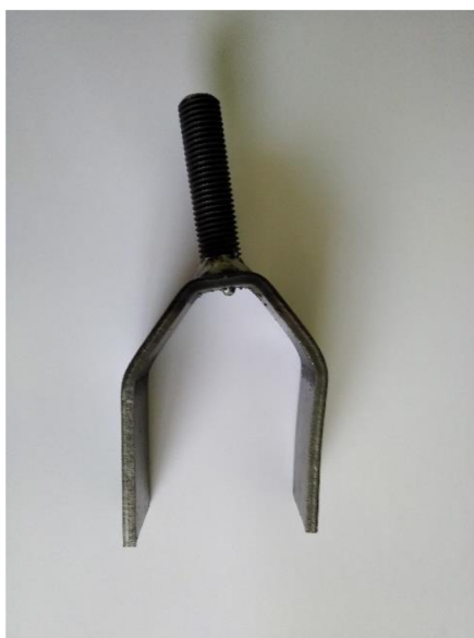
Obr. 46 Deformace zkušebního vzorku na tlak
