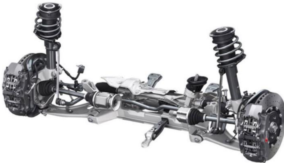
Obr. 21 Řízená hnací náprava McPherson AUDI R8 [9]
