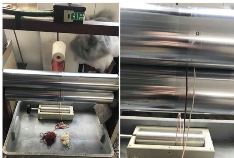
Obrázek 3.3: Hydrofilizace příze aviváže přes válce
