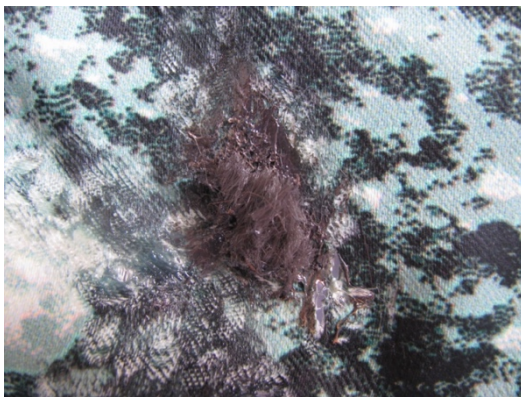
Obrázek 34: Přitavená umělá kožešina k materiálu [26]
