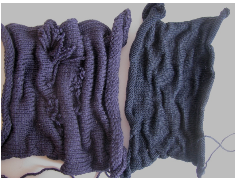
Obrázek 37: Zátěžná jednolící pletenina s nepravidelně umístěnou chytovou kličkou [26]
