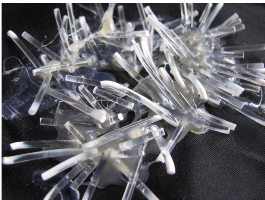
Obrázek 31: Struktura z nalámané tiskové struny, přilepené tavnou pistolí [26]
