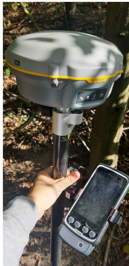
Obrázek 4: Přijímač GNSS-RTK Trimble R8s
