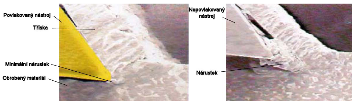
Obr. 2.3 Tvorba nárůstku u nástroje s povlakem a bez povlaku 13
