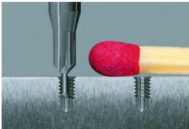
Obr. 1.3 Porovnání velikosti frézy a hlavičky sirky 4
