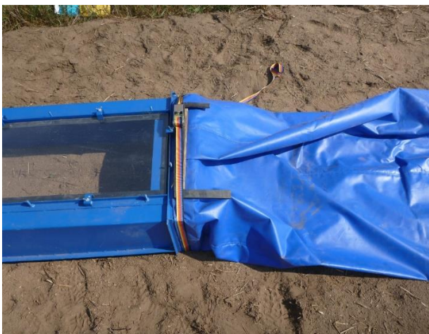
1. Umístění a připevnění rukávu na vstup
