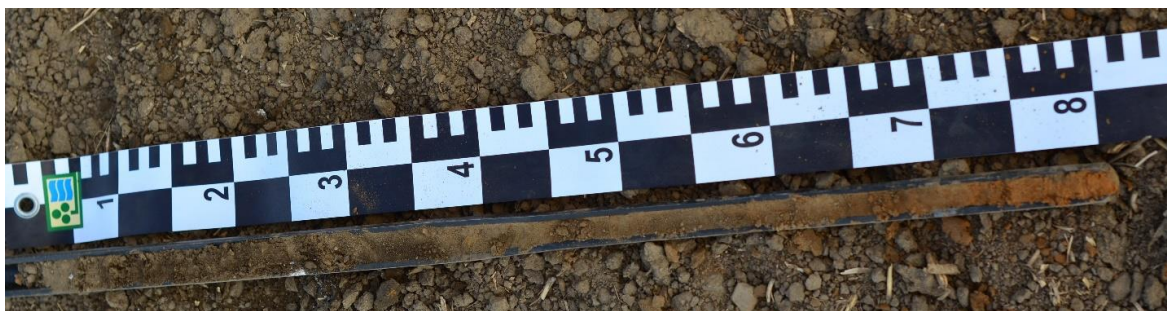
Obr. 15 Fotografie půdní sondy a půdního metru pro měření č. 6
