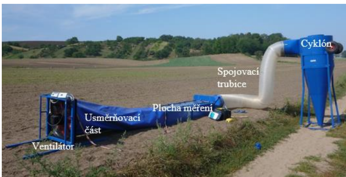
Obr. 2 Popis součástí mobilního simulátoru větru
