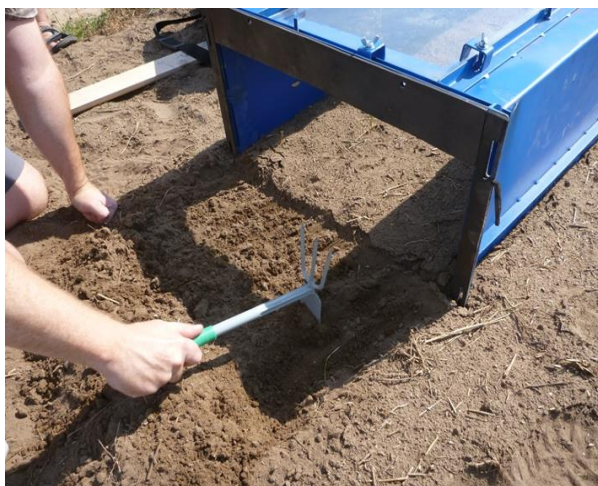
3. Odhrabání půdy pro instalaci výstupního hrdla
