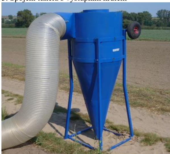
7. K výstupu tunelu je umístěna hadice a cyklón
