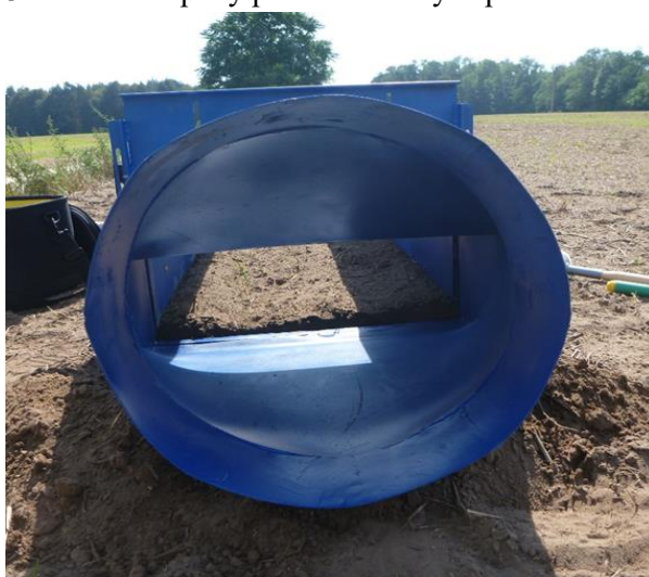
5. Spojení tunelu s výstupním hrdlem
