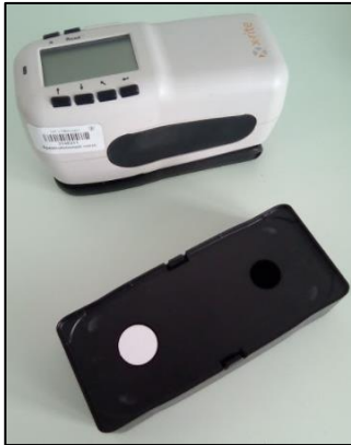
Obr. 25: Spektrální fotometr SP-62, v popředí kalibrační kazeta, foto R. Šimáček (2018).
