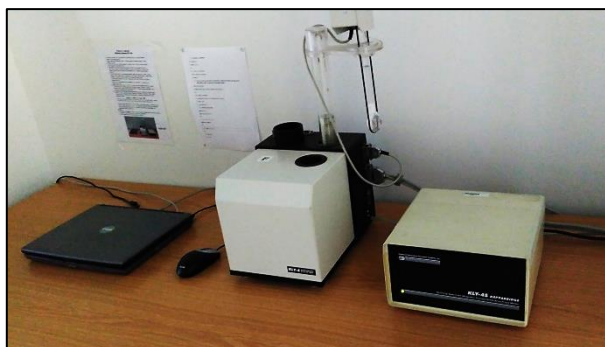
Obr. 22: Laboratorní kappa můstek katedry geologie UPOL, foto R. Šimáček (2017).
