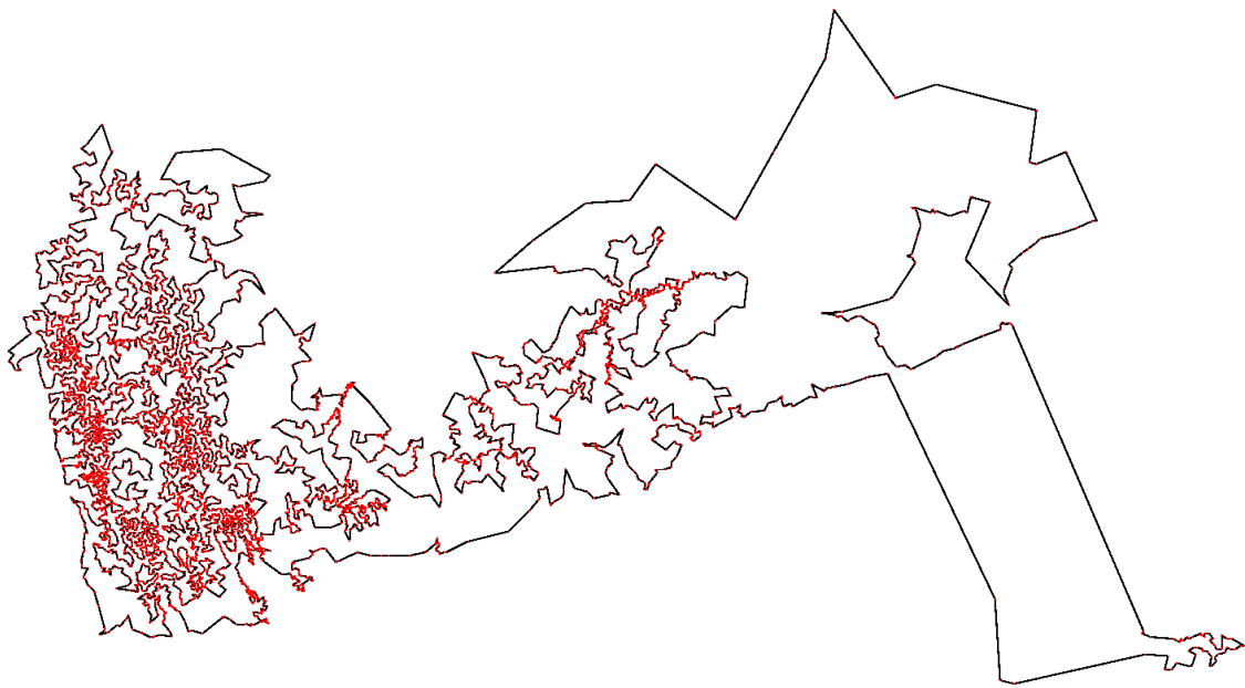
Obr. 2.5: Ukážka nájdenej optimálnej cesty TSP inštancie štátu Jemen, ktorej dĺžka je 238 314 kilometrov s nepresnosťou 0,030% oproti exaktnému riešeniu získanému algoritmom používajúcim hodnoty s pohyblivou desatinnou čiarkou. 6
