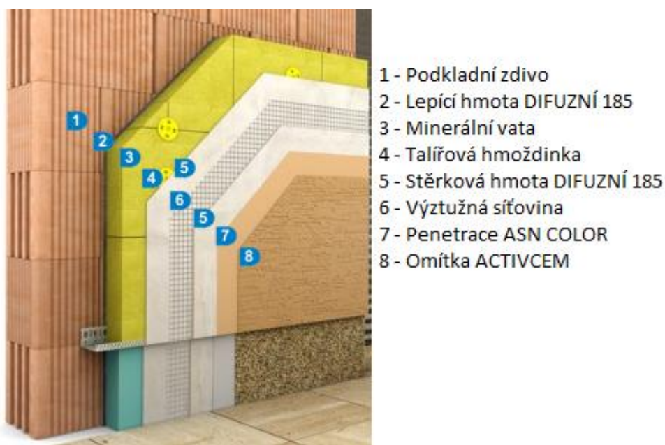
Obrázek 5 Znárodnění uspořádání skladby difuzně otevřeného systému Cemix [8]
