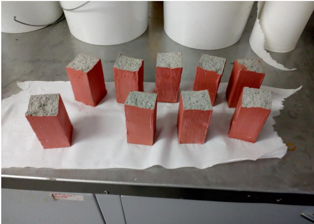
Obrázek 13 Fotografie zkušebních vzorků při zkoušce stanovení kapilární nasákavosti
