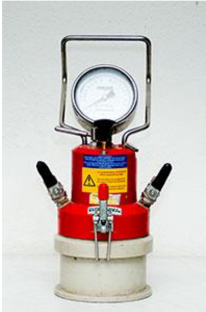
Obrázek 8 Fotografie přístroje pro stanovení obsahu vzduchu v maltě [14]
