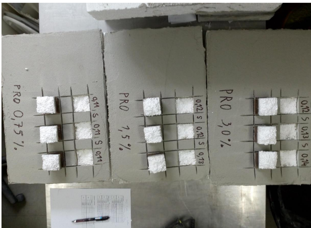
Obrázek 12 Fotografie zkušebních vzorků ze zkoušky stanovení soudržnosti mezi lepicí hmotou a izolačním výrobkem
