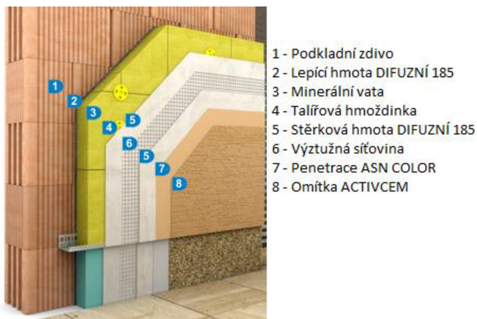
Obrázek 5 Znárodnění uspořádání skladby difuzně otevřeného systému Cemix [8]
