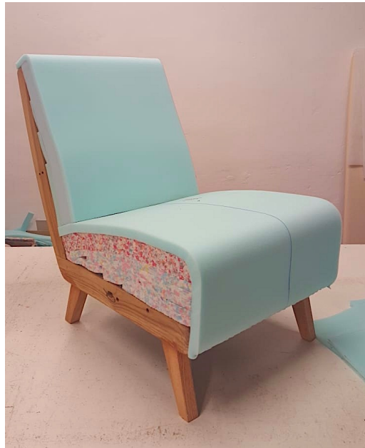
Obrázek 22 - Vytvarování sedáku a opěradla molitanem (Mikešová, 2018)
