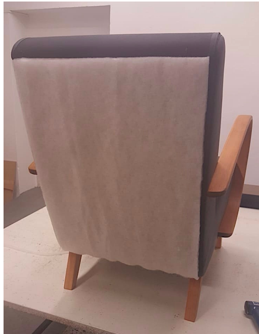
Obrázek 26 - Zadní část opěradla včetně potažení rounem (Mikešová, 2018)
