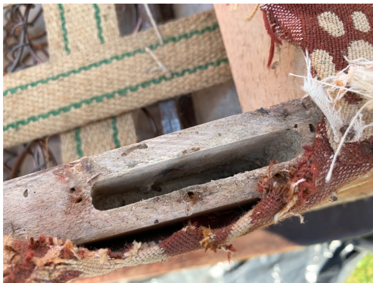
Obrázek 11 - Konstrukce křesla napadená dřevokazným broukem (Mikešová, 2018)
