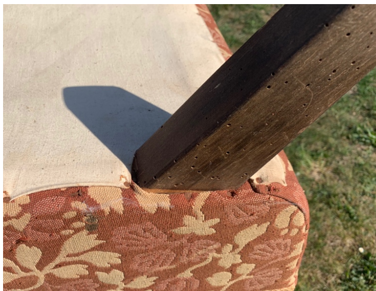
Obrázek 10 - Detail nohy napadené dřevokazným broukem (Mikešová, 2018)
