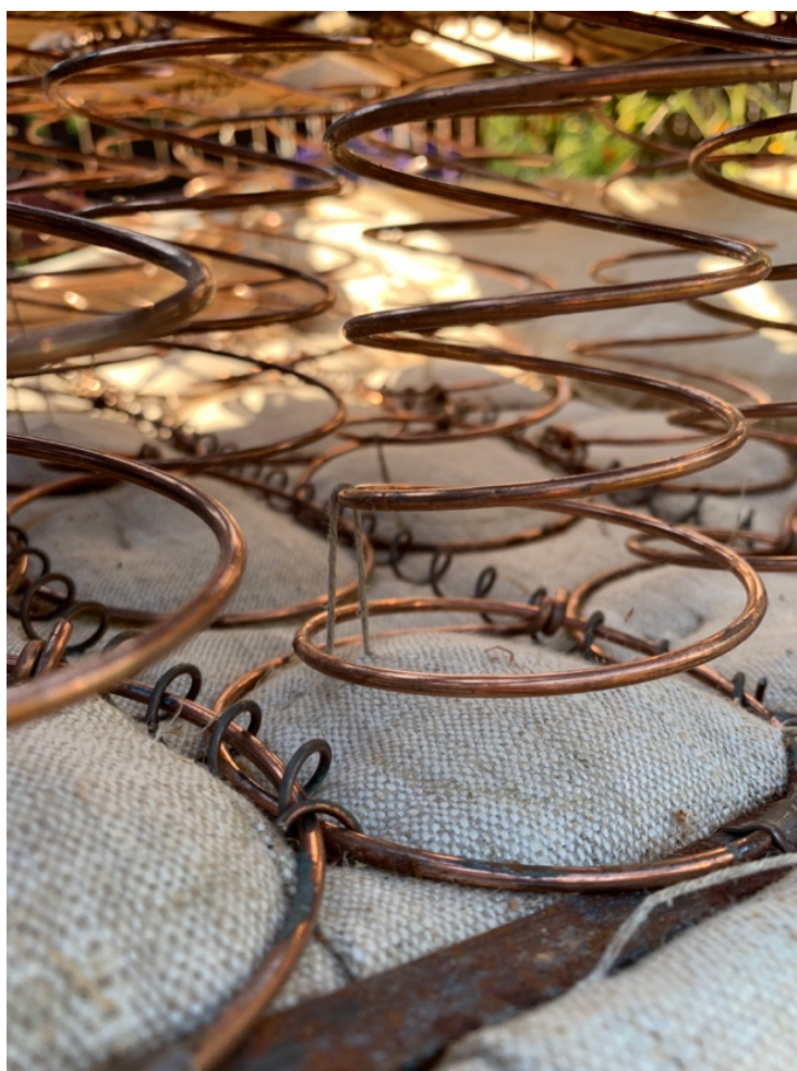
Obrázek 13 - Detail vázání tlačných pružin (Mikešová, 2018)
