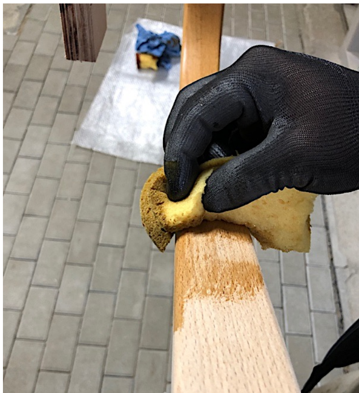
Obrázek 19 - Nanášení voskového oleje pomocí houbičky (Mikešová, 2018)
