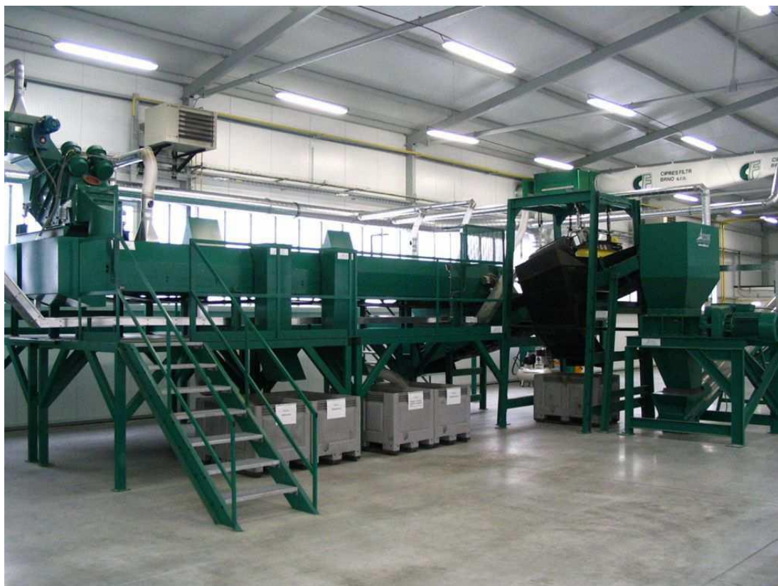
Obrázek č. 17 „Linka na zpracování vyřazených elektrospotřebičů“
