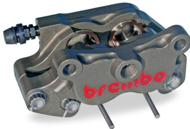
Obrázek 18 Brzdový třmen Brembo P4-24 použit na ED2 [7]
