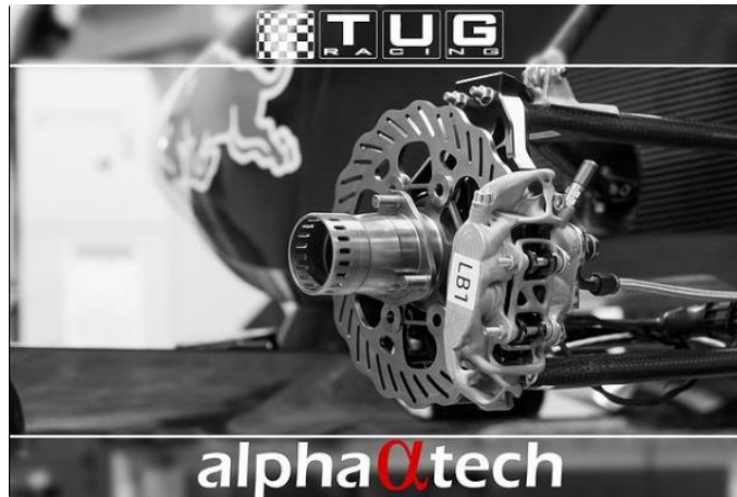
Obrázek 14 Konstrukční řešení brzdového kotouče týmu TU Graz Racing [16]
