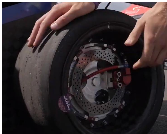
Obrázek 15 Hubless konstrukce týmu TU Delft [17]
