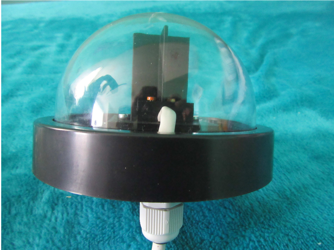
Obr. 3.11: Hotové čidlo slunečního svitu
