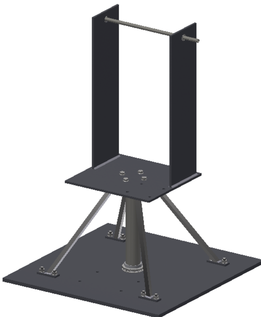
Obr. 3.18: Model pohyblivého stojanu pro malý koncentrátor
