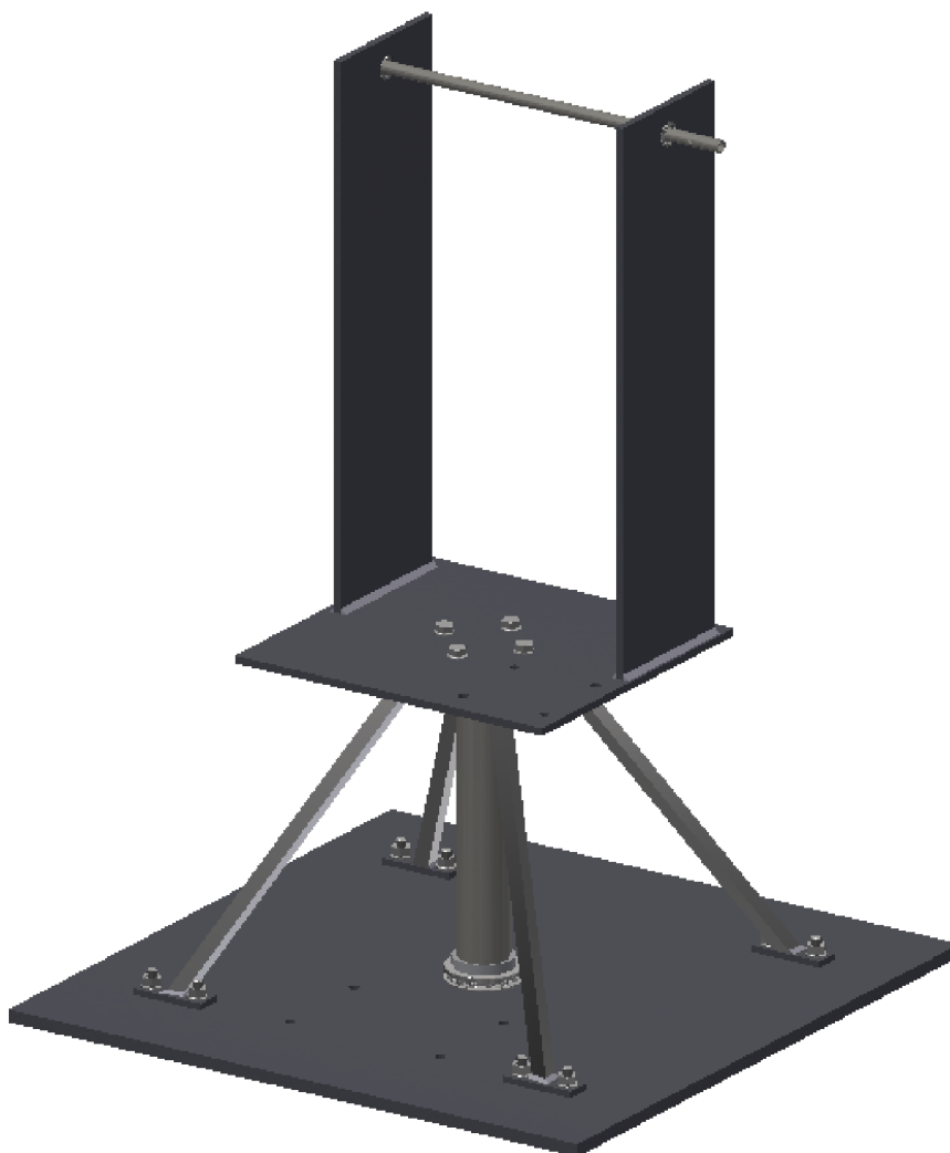
Obr. 3.18: Model pohyblivého stojanu pro malý koncentrátor
