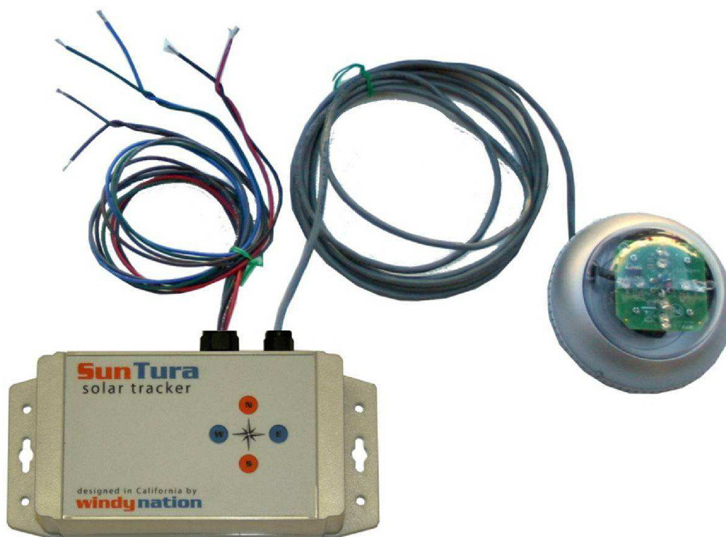
Obr. 4.6: Tracker SunTura s čidlem slunečního svitu
