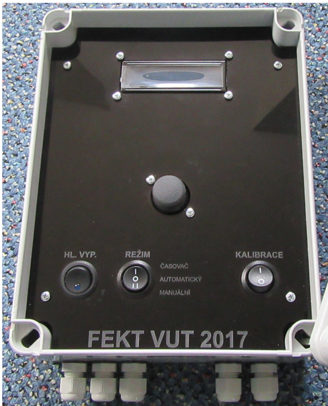
Obr. 4.2: Hotový tracker s krytem
