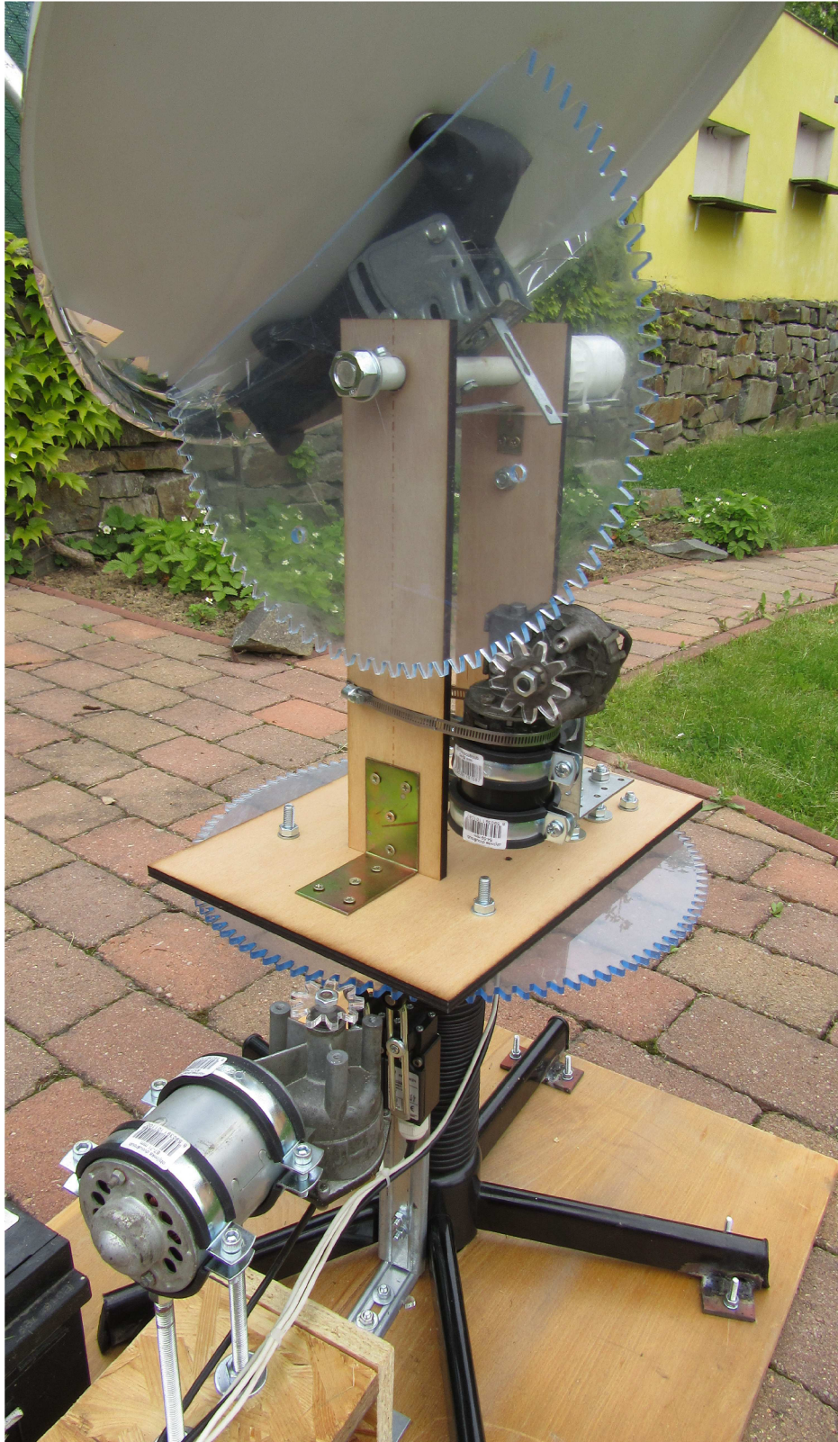
Obr. 4.4: Pohyblivý stojan včetně koncentrátoru (boční pohled)
