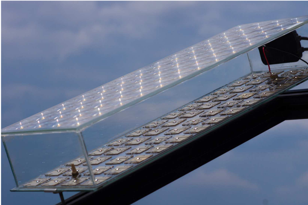
Obr. 1.8: Fotovoltaický panel s koncentrátorovým modulem FLATCON
