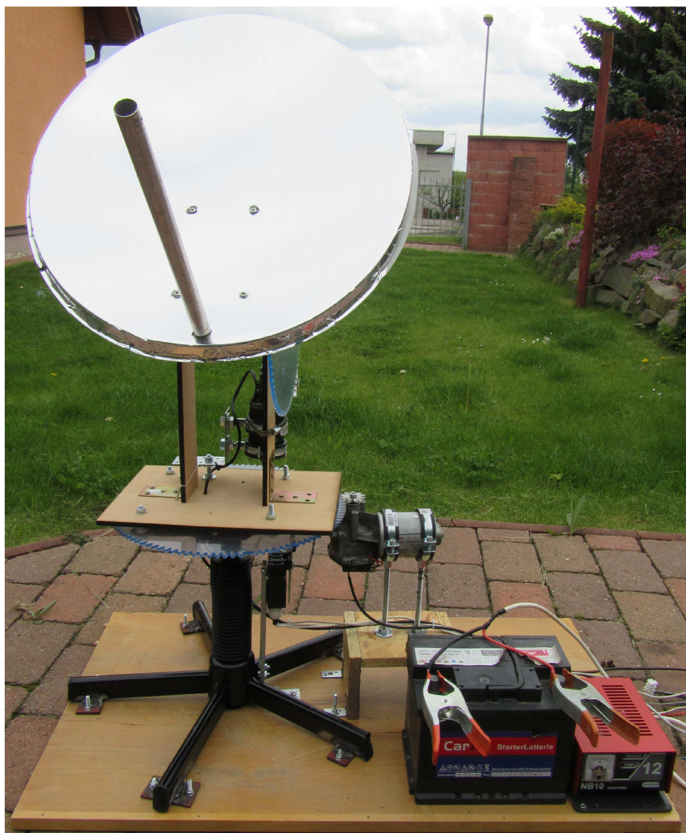
Obr. 4.3: Pohyblivý stojan včetně koncentrátoru (přední pohled)
