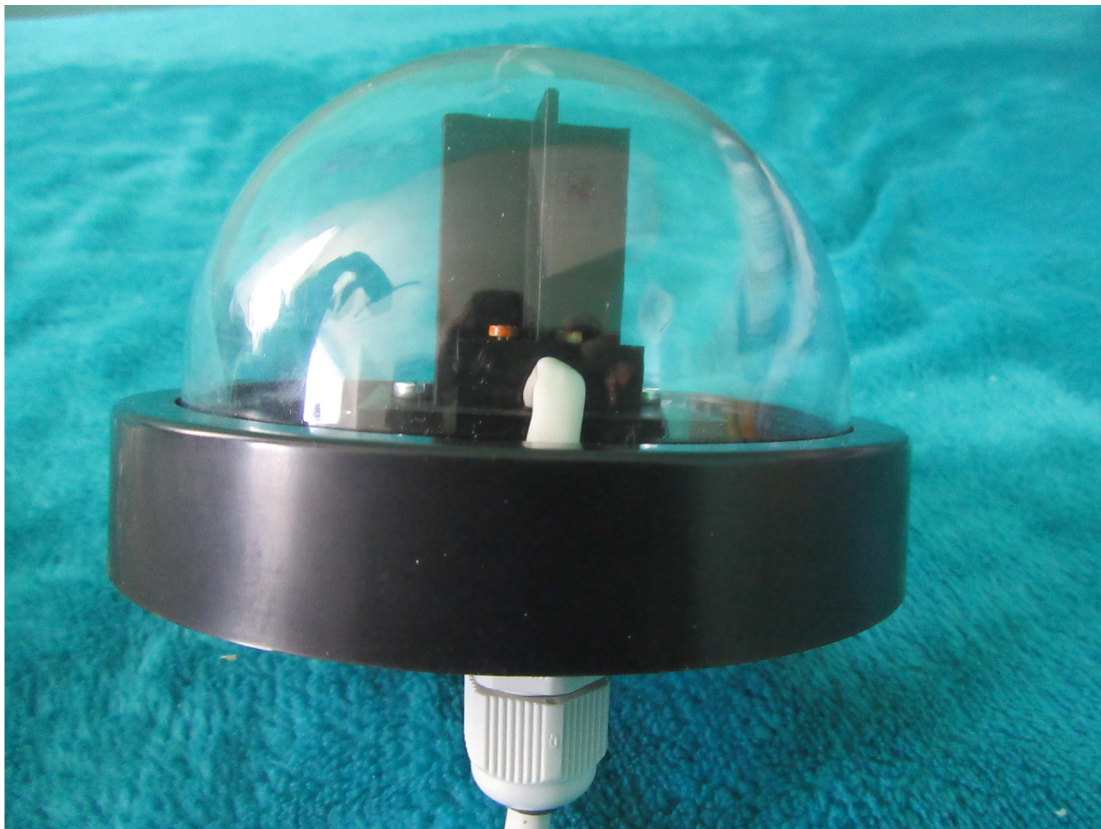
Obr. 3.11: Hotové čidlo slunečního svitu
