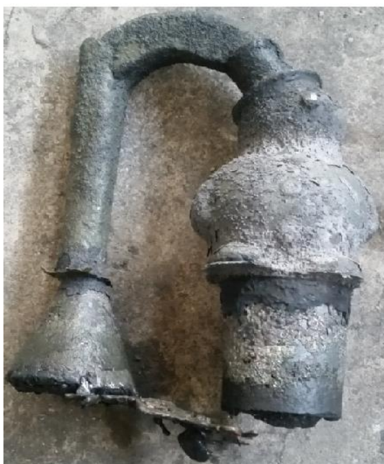
Obr. 38 Odlitek a vtoková soustava s nálitekem před a po otryskání
