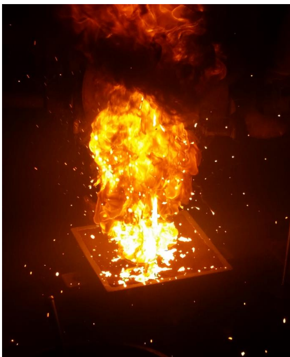
Obr. 37 Reakce plynů, vznikajících z polystyrenového modelu
