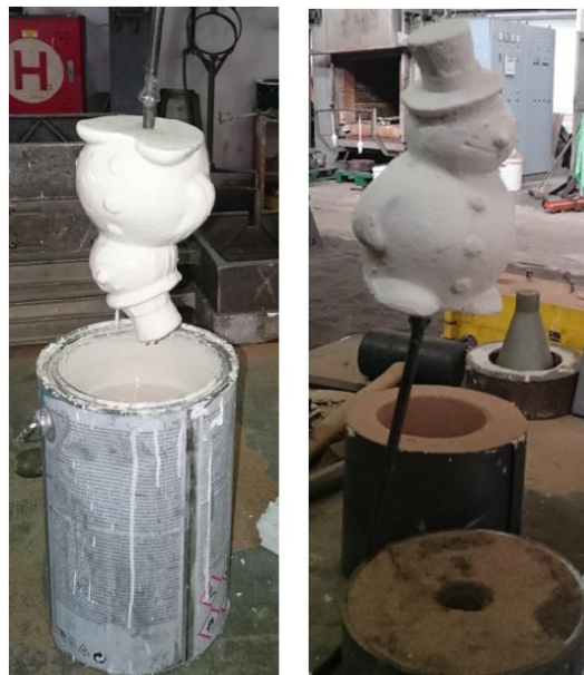
Obr. 34 Nanášení nátěru a sušení
