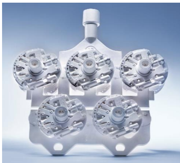
Obr. 16 Ukázka vtokové soustavy [9]
