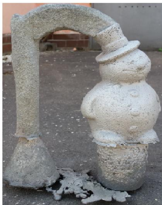
Obr. 38 Odlitek a vtoková soustava s nálitekem před a po otryskání
