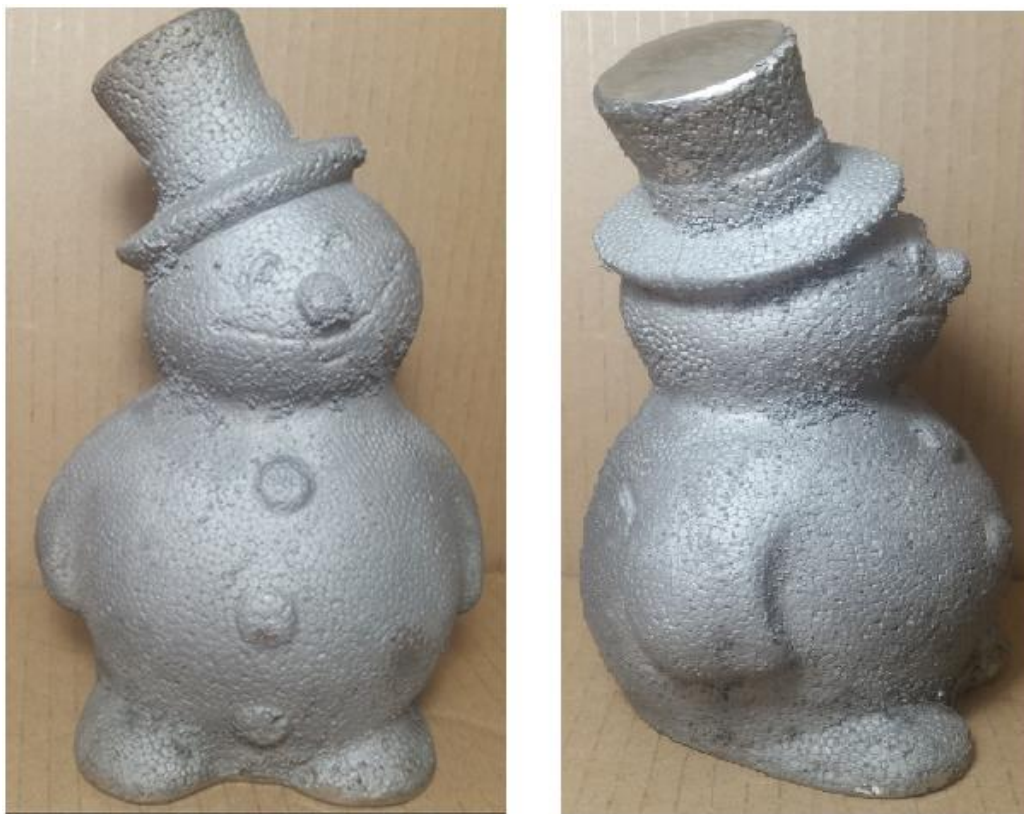
Obr. 39 Výsledný odlitek po odstranění vtokové soustavy a nálitku
