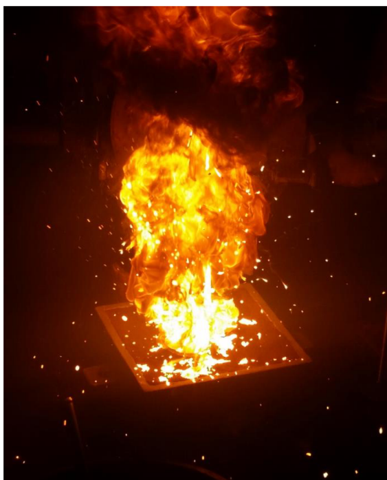
Obr. 37 Reakce plynů, vznikajících z polystyrenového modelu
