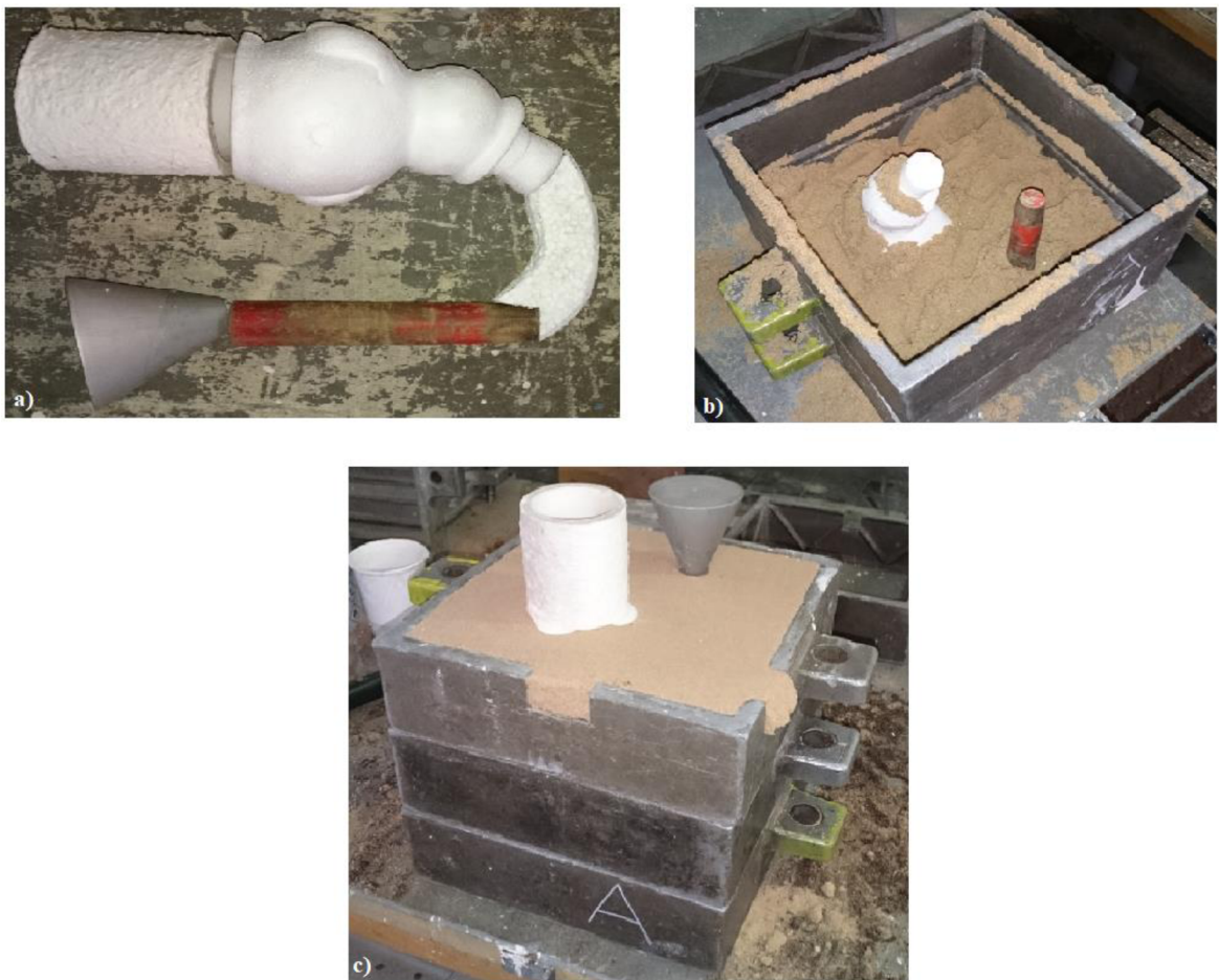
Obr. 35 a) Sestava modelu b) průběh formování c) formování vršku formy
