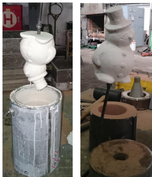
Obr. 34 Nanášení nátěru a sušení
